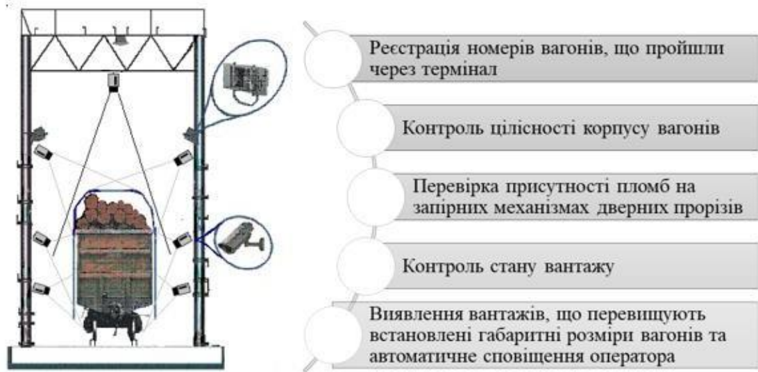
Рис.1. Стационарний відеоконтрольний термінал та його функції
