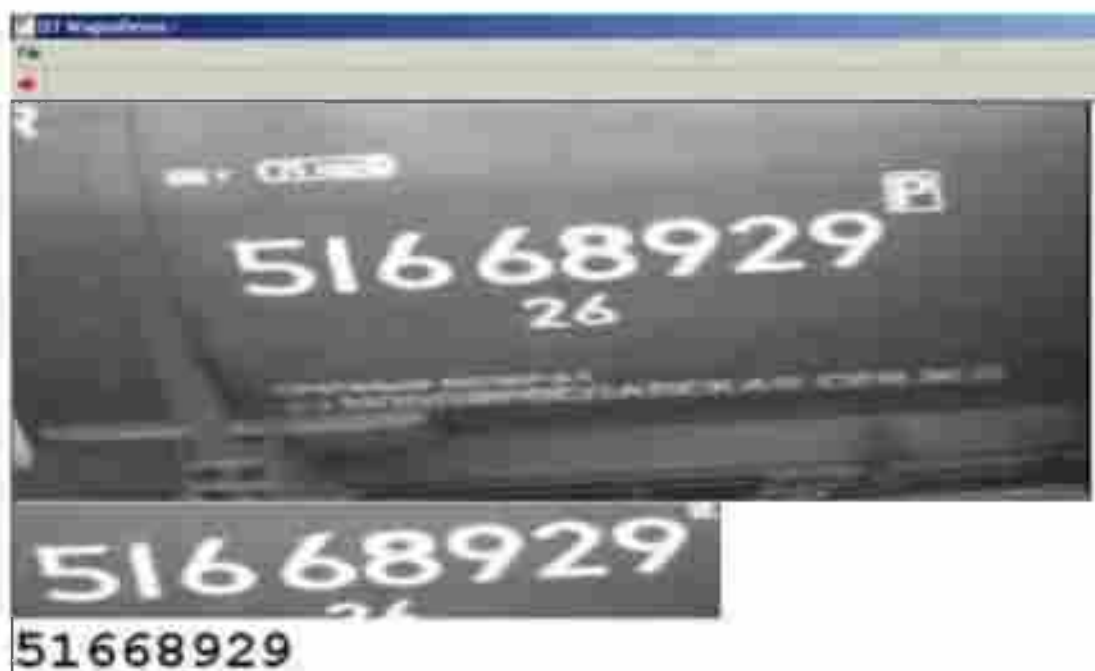
Рисунок 4.3 – Оптичне зчитування номерів вагонів
