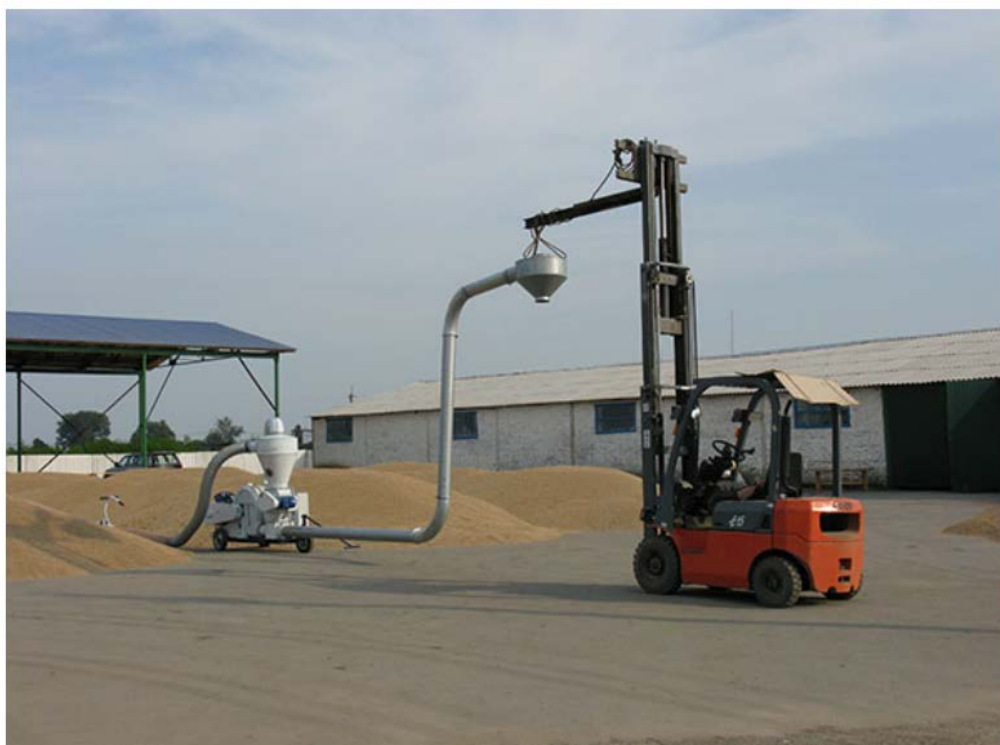
Рисунок 3.3 – Принцип дії пневмотранспортера
