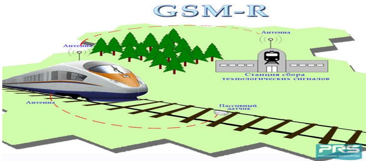
Рисунок 2.2 – Контроль дорожнього руху за допомогою GSM-R (другий рівень)
