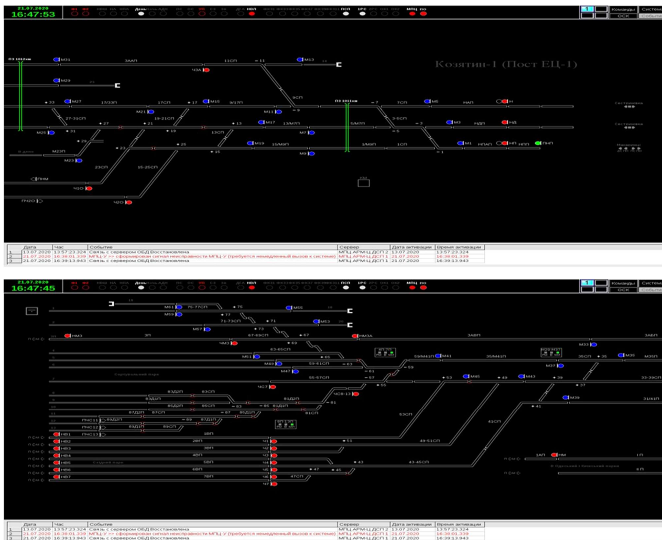
Рисуно 3.3 – Схематичний план станції (колійний розвиток) відображається в третій зоні монітора АРМ-Ц
