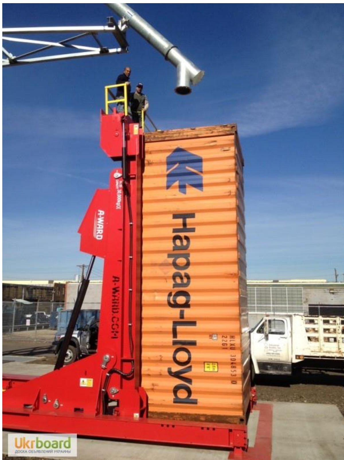
Рисунок 6.1.3 – Вертикальне навантажування контейнера
