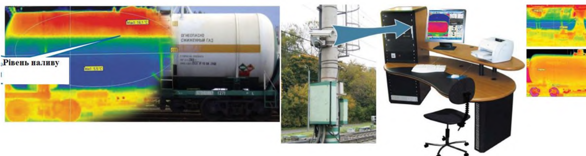
Рисунок 4.2 – Схема контролю наливу вантажу та температури
