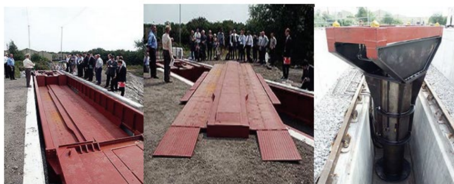
Рисунок 2.4 – Система «CargoSpeed», платформа «wellfloor» та підйомний механізм
