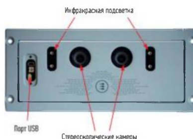
Рисунок 7.1 – Лічильник людей DynaPCN 10-20 компанії Eurotech
