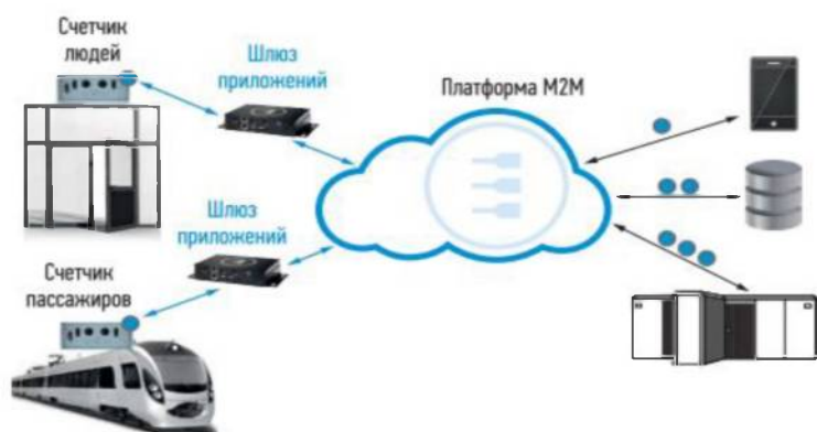
Рисунок 7.2 – Система підрахунку людей із застосуванням хмарних технологій
