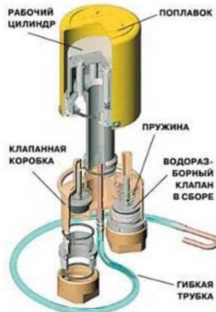
Рисунок 6.2 – Запірний клапан системи водопостачання для пасажирських вагонів виробництва Німеччини
