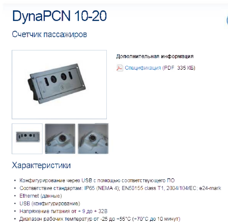
Рисунок 8.2 – Лічильник пасажирів DynaPCN 10-20 компанії Eurotech
