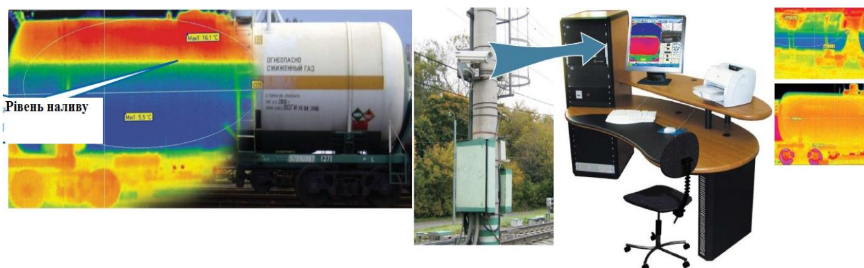
Рисунок Ж.2 – Схема контролю наливу вантажу та температури
