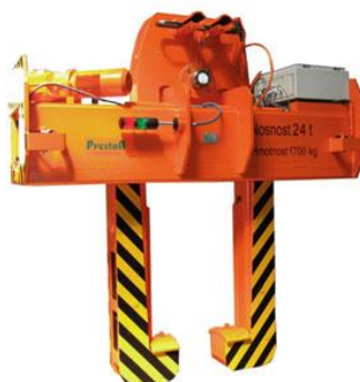
Рисунок 3.4 - Телескопічні кліщі для транспортування рулонів листового заліза в горизонтальному положенні забезпечити рівномірний розподіл вантажу щодо поперечної і поздовжньої осей платформи.
