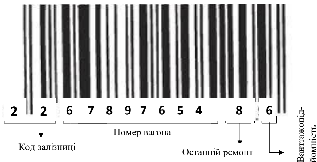
Рисунок 5.2 – Штрих-код, який містить інформацію про номер вагона та його технічну характеристику
