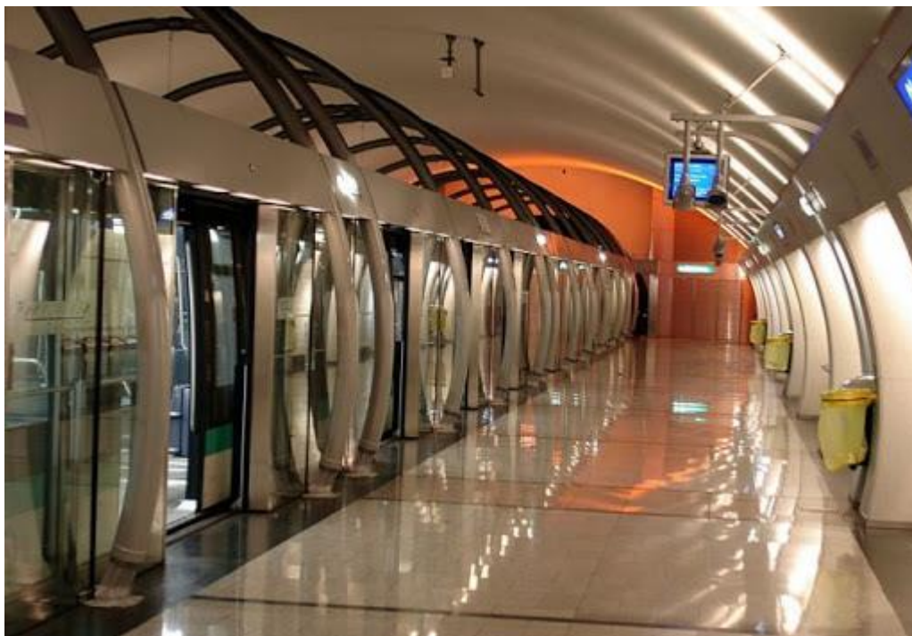
Рисунок 1.2 – Станція глибокого залягання в метрополітені Парижу, що обладнана автоматичними платформними дверима.
