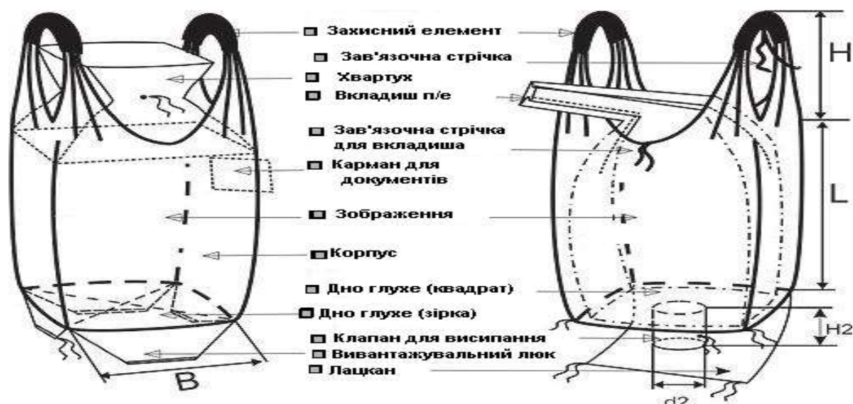
Рисунок 1.1 – Конструкція біг-бега
