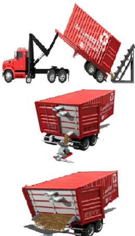
Рисунок Д.2 - Способи вивантаження вантажів із Red Dry Liners™
