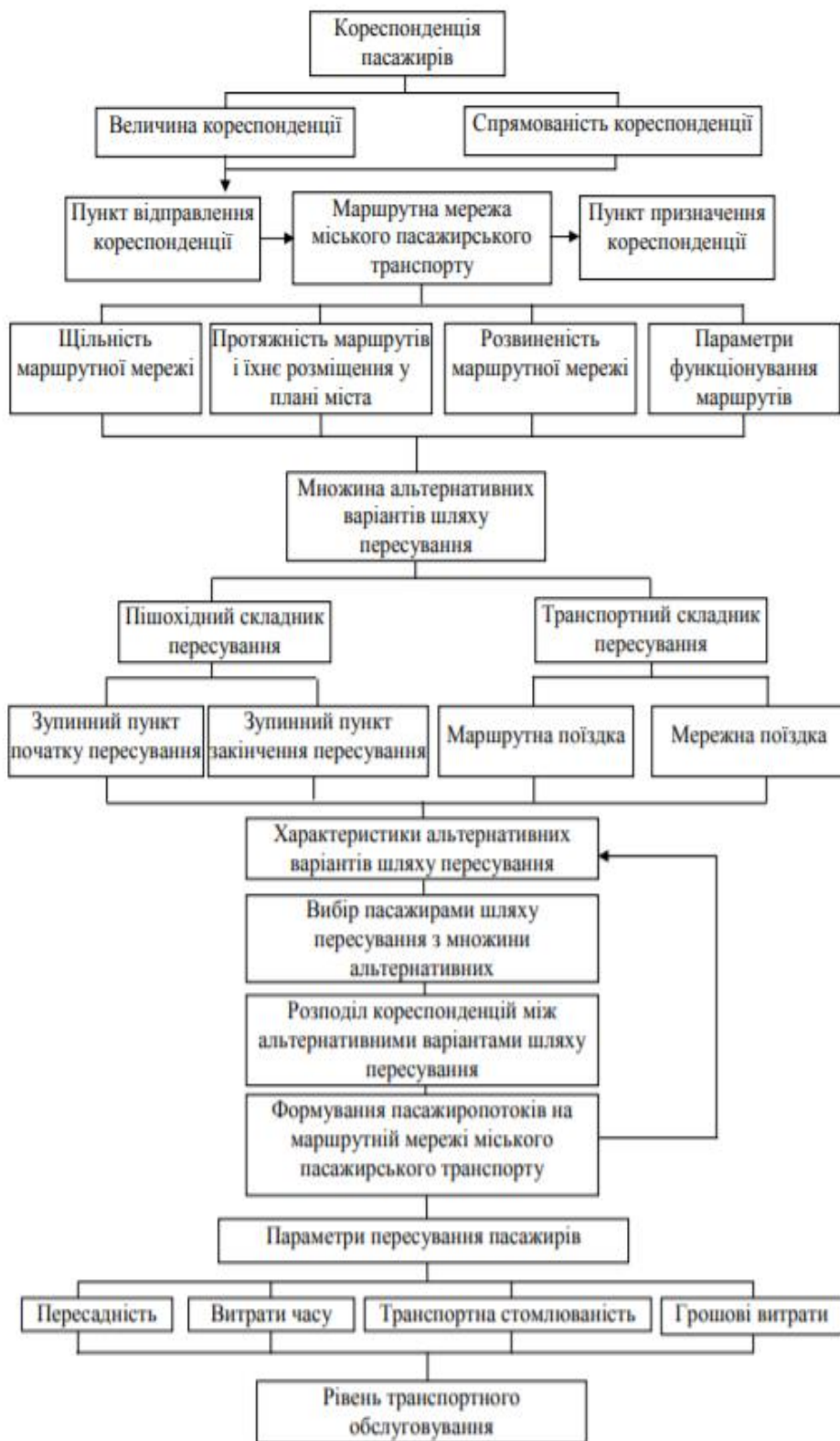
Рисунок 3.8 – Структурна схема процесу формування пасажиропотоків на маршрутній мережі міського пасажирського транспорту
