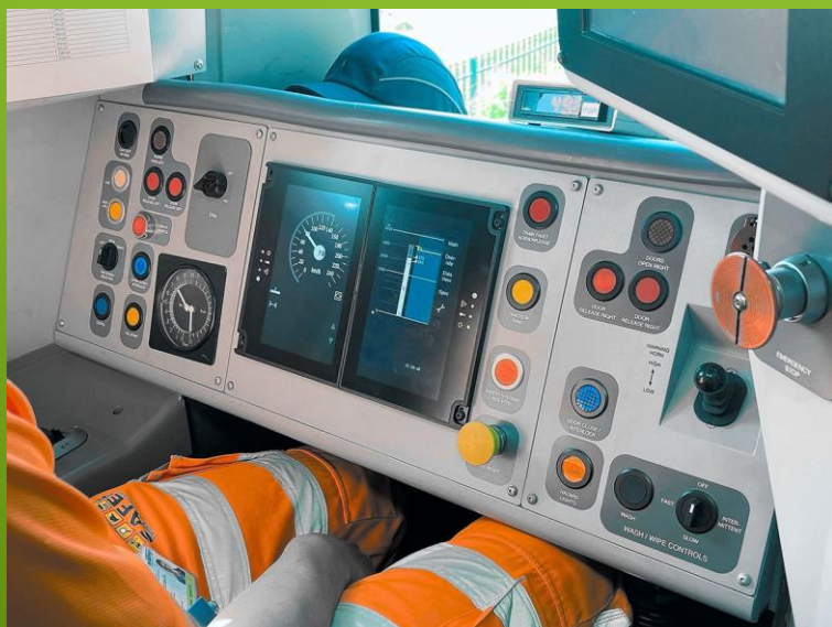
Рисунок –система ETCS в кабіні машиніста
