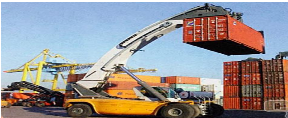
Рисунок 1.4 – Річстакер LRS645 компанії Liebherr
