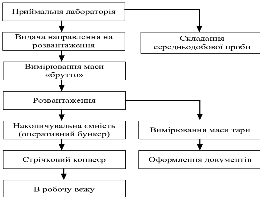
Рисунок 1.1 – Принципова схема технологічного процесу прийому зерна від автотранспорту
