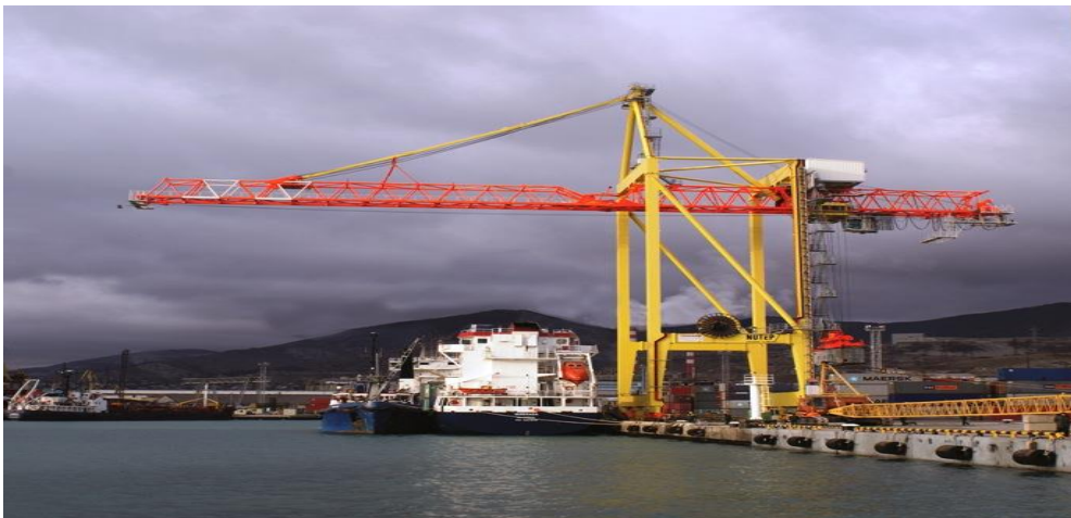
Рисунок 3.11 – Причальний кран типу Panamax компанії «Liebherr»
