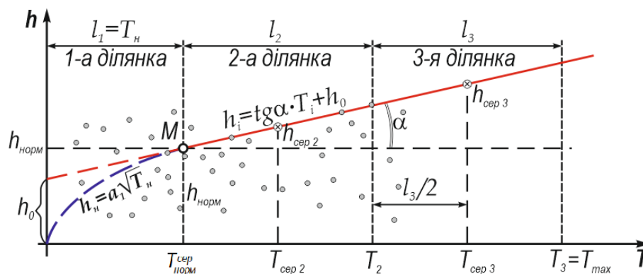
Рисунок 2 – Схема для визначення рівняння прямої ділянки кривої зносу h = \text{tg}\alpha \cdot T_i + h_0
