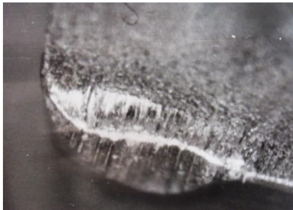
Рис. 1 – Вигляд зносу ріжучого інструменту при точінні сплаву ХН67МВТЮ інструментом з твердого сплаву ВК6М при V = 1,1 м/с
