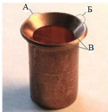
Рис. 2. Якісно розвальцьована труба: А — гладка дзеркальна поверхня, ширина розвальцьованої ділянки труби всюди по колу однакова; Б — край розвальцьованої ділянки труби рівний, без борозен і вм'ятин; В — чітка внутрішня кромка
