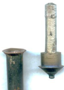
Рис. 3. Зображення мідної труби після розвальцювання і конуса для розвальцювання
