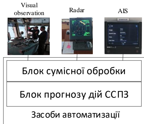
Рисунок 2.6 – Узагальнена структурна схема сумісної обробки даних про навігаційну обстановку від різних джерел інформації
