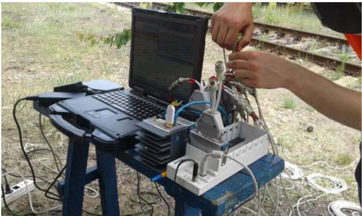
Рисунок 4.4 – Комплект обладнання використовується для визначення величин напружень та прискорень
