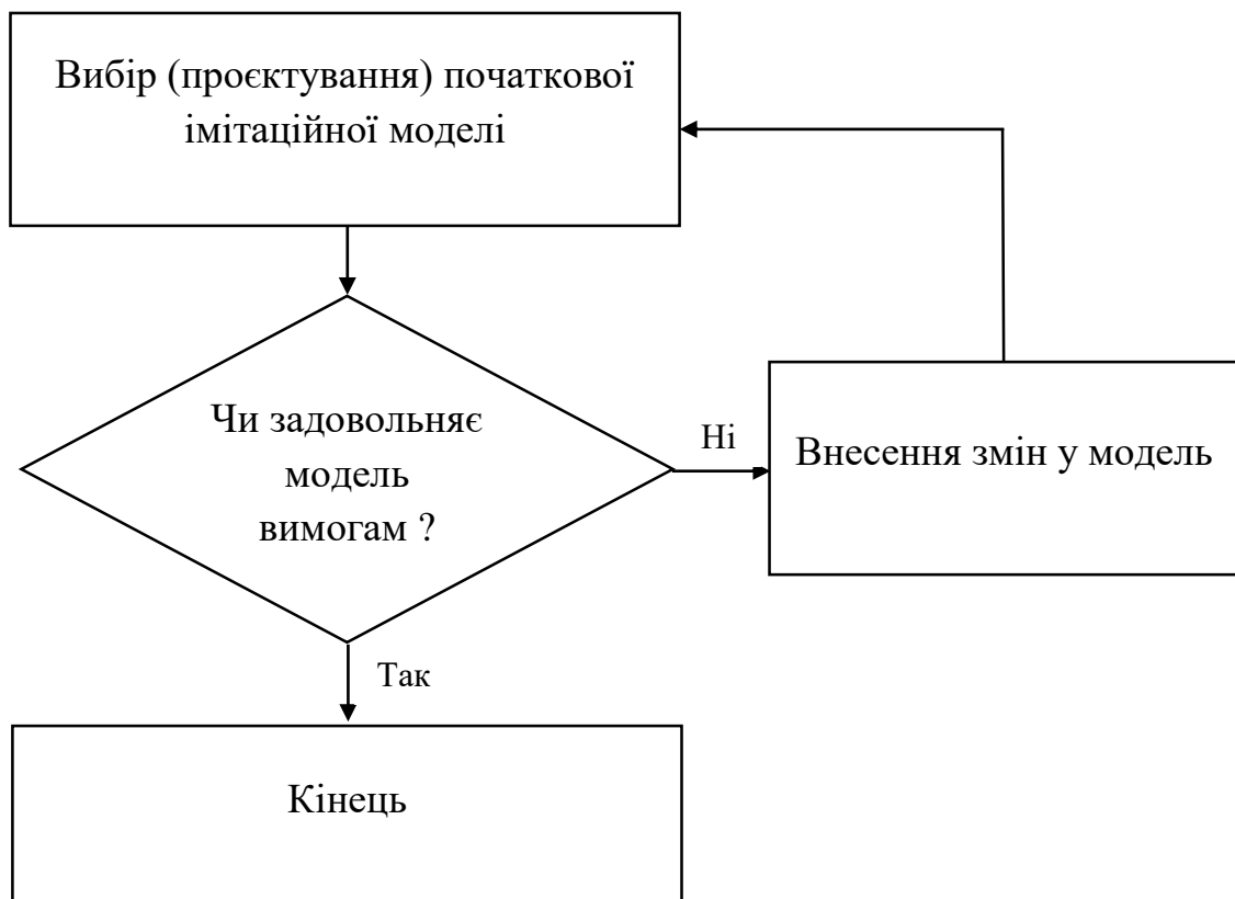
Рисунок 3.2 – Схема проектування за циклічним ітераційним методом
