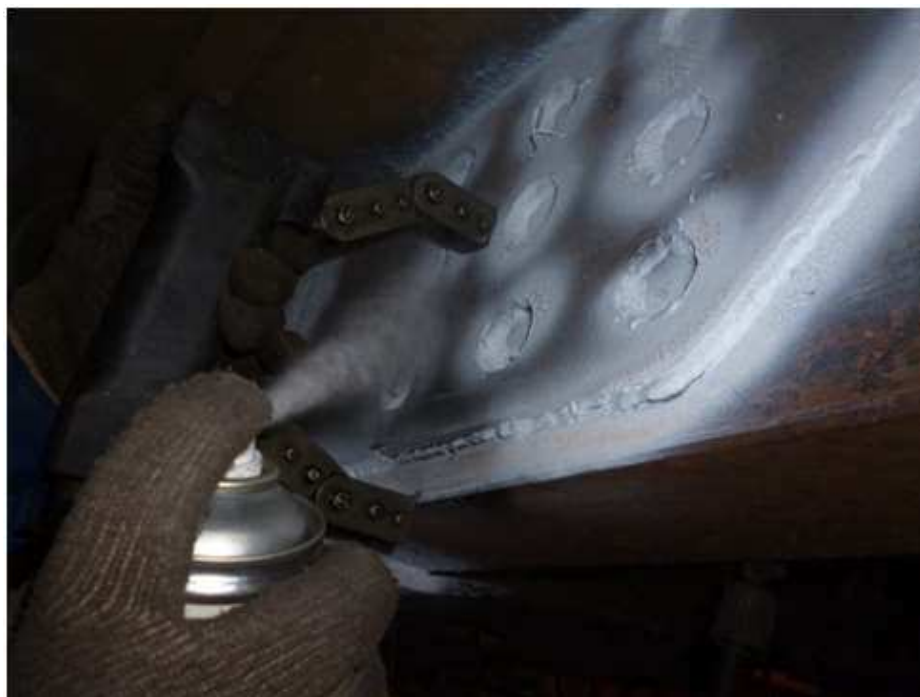
Рисунок 4.2 – Проконтрольоване місце модернізації дослідного зразка
