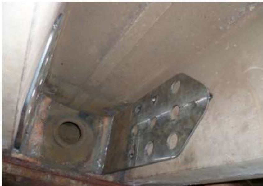
Рисунок 4 – Модернізація рами вагона-зерновоза
