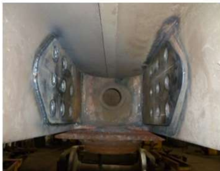
Рисунок 5 – Встановлена деталь на хребтову балку
