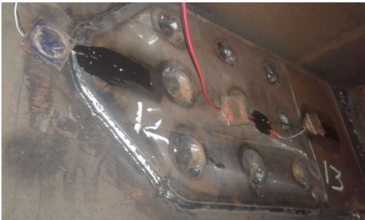
Рисунок 4.15 – Установка тензорезисторів в зоні модернізації №№ 12, 13
