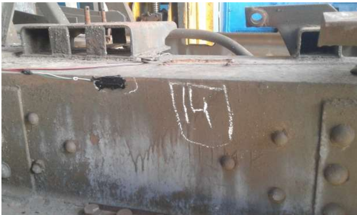
Рисунок 4.16 – Установка тензорезистора №14 на хребтовій балці
