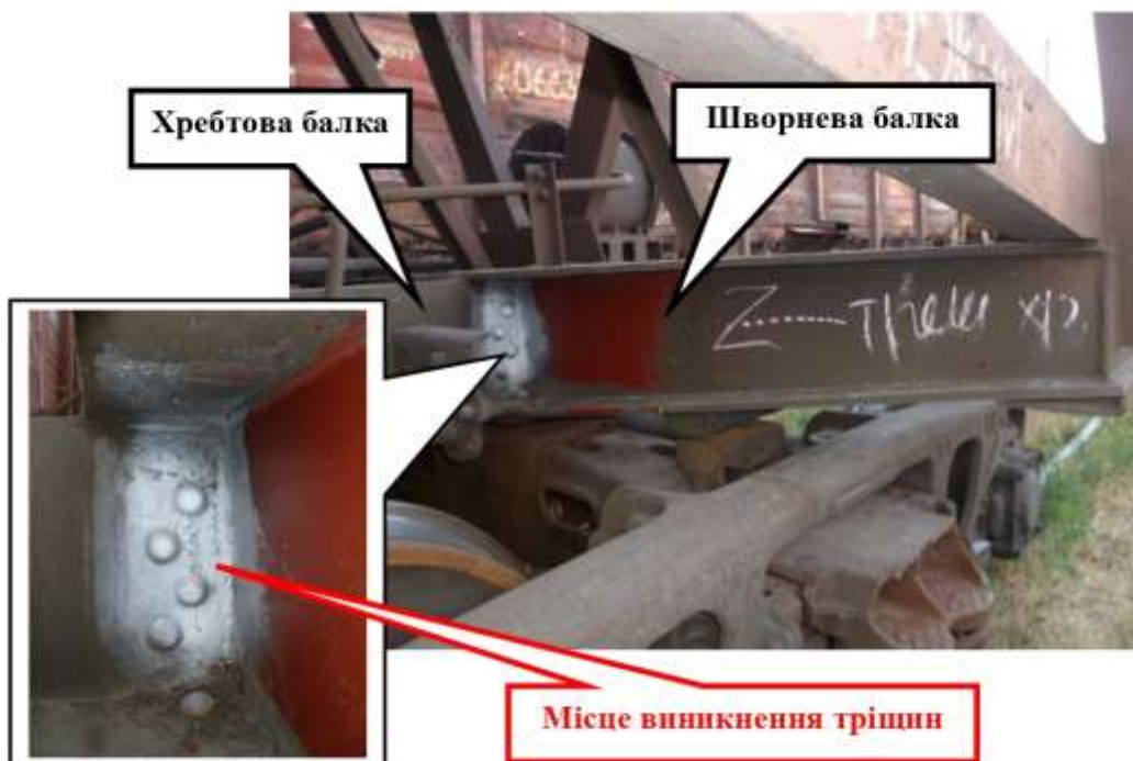
Рисунок 1 – Місце виникнення тріщин в хребтових балках вагонів-зерновозів моделі 19-752, що підлягають модернізації згідно цієї ТІ
