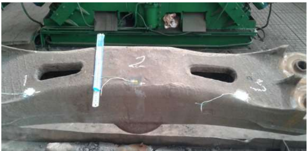
Рисунок 4.9 – Встановлення тензорезисторів № 1, 2, 3
