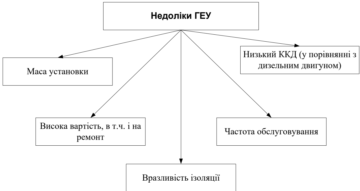
Рисунок 1.2 – Основні недоліки гребної електричної установки
