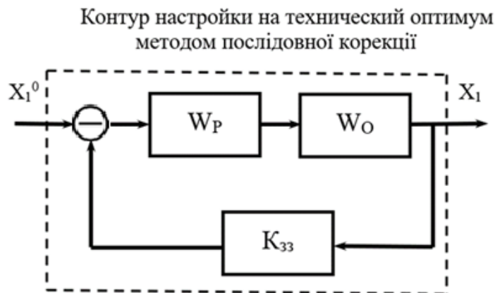
Рисунок 1.9 – Формування бажаних перехідних характеристик методами послідовної корекції:
