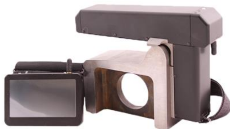
Рис. 2. Лазерний профілометр поверхні кочення колісних пар серії ІКП
