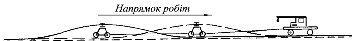
Рис. 1. Заміна інвентарних рейок на зварні пліті двома візками
