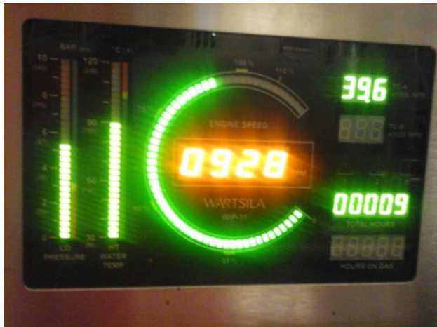
Рисунок 1 – Измерение числа оборотов двигателя дизеля типа 6L20 на судне
