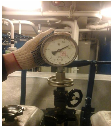
Рисунок 2 – Замер давления в цилиндре типа 6L20 на судне
