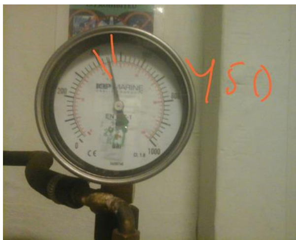
Рисунок 4 – Проверка и регулирование давления начала впрыска топлива на судне
