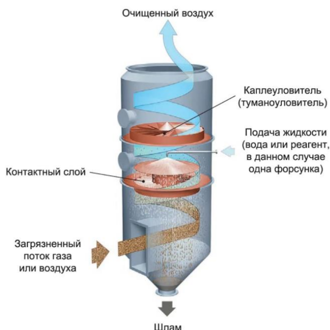
Рисунок 2 – Устройство скруббера
