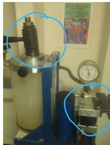
Рисунок 4 – Проверка и регулирование давления начала впрыска топлива на судне
