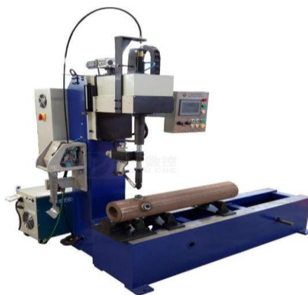
Рисунок 3 – Автоматична зварювальна установка фітингів китайського виробника HAOYU [4]
