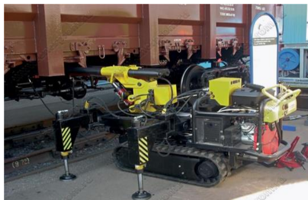
Рисунок 1 – Мобільна установка правки та заміни люків напіввагонів
