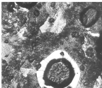
Рисунок 1 – Мікроструктура досліджуваного чавуну в литому стані, травлення 4 % азотною кислотою, \times 340
