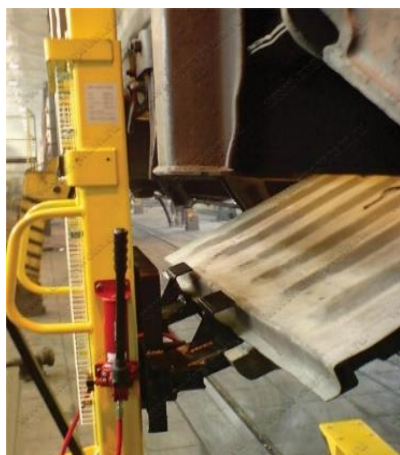
Рисунок 3 – Установка знімання-встановлення кришок люків напіввагонів
