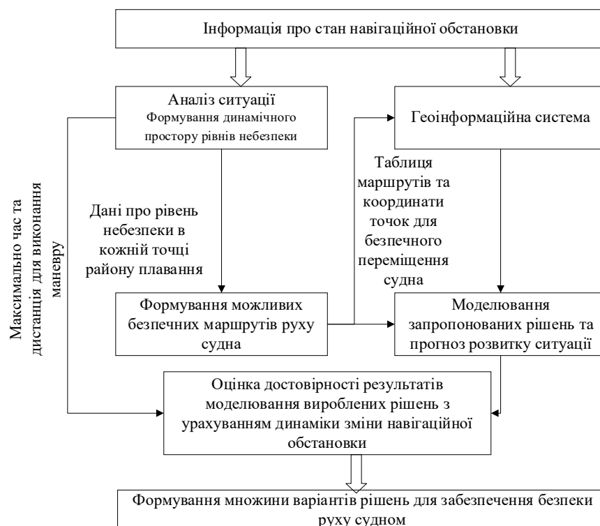
Рисунок 3.4 – Структурно-логічна (концептуальна) модель системи підтримки прийняття рішення судноводія в ергатичній системі "судноводій-судно"
