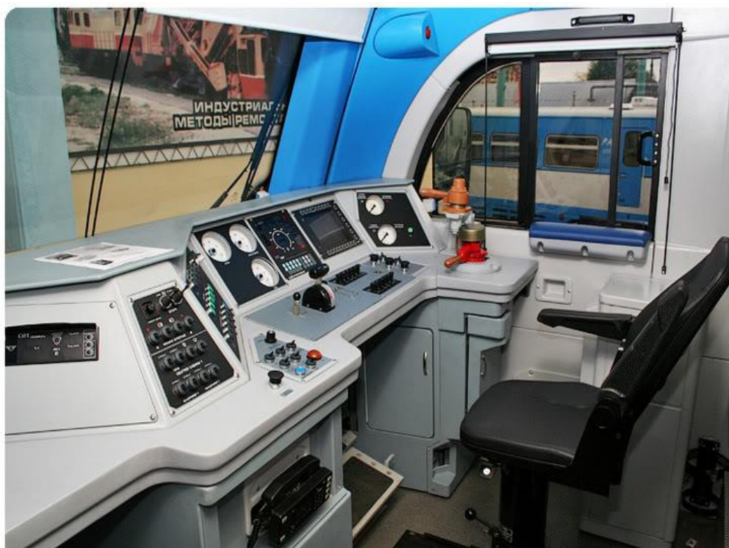
Рисунок 1.7 – Пульт электровозу змінного струму Е5К
