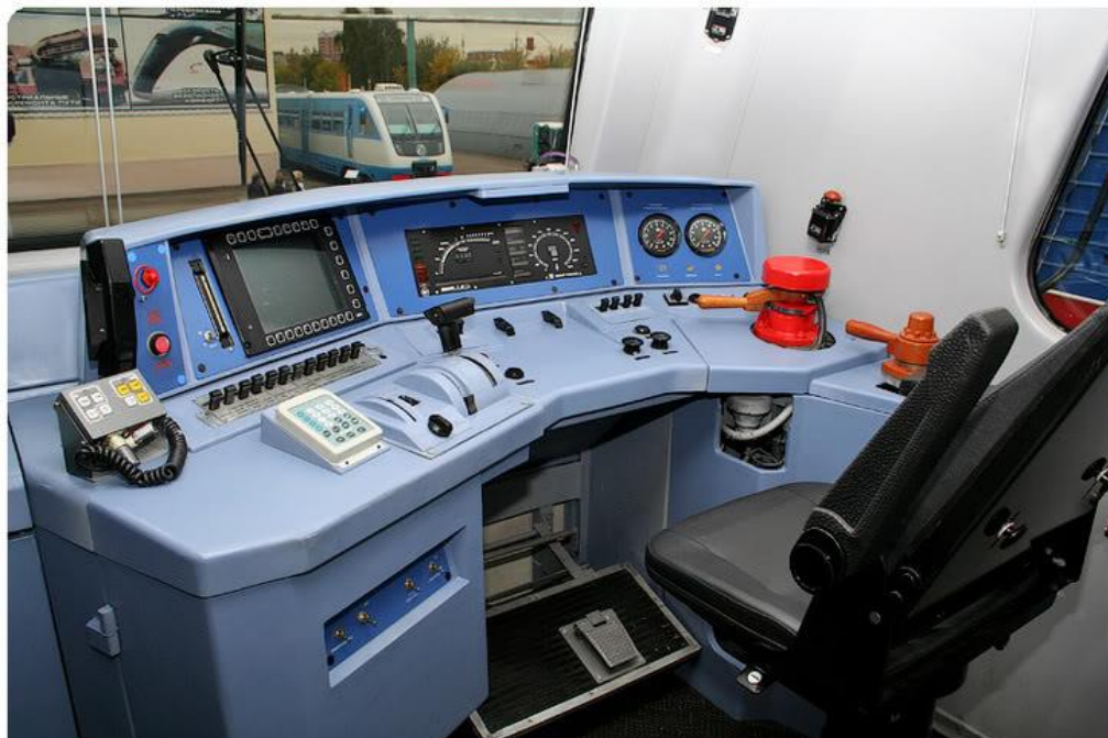
Рисунок 1.4 – Пульт електровозу постійного струму ЕП2К
