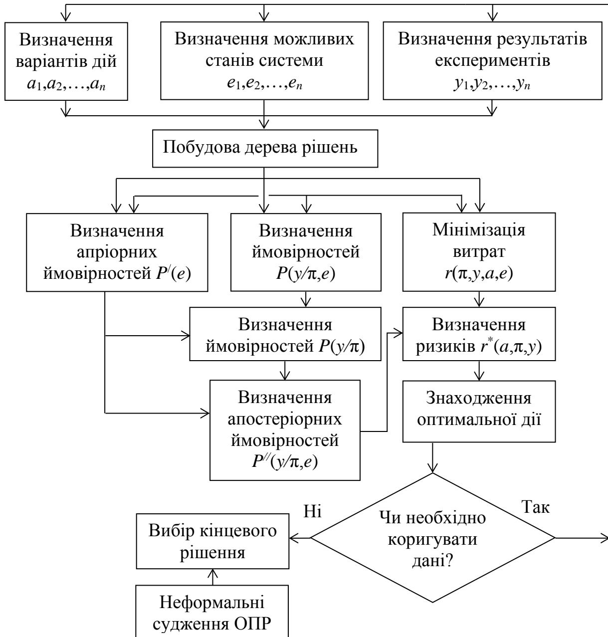
Рис. 2.6. Блок-схема пошуку оптимального розв'язку в системі технічної діагностики
