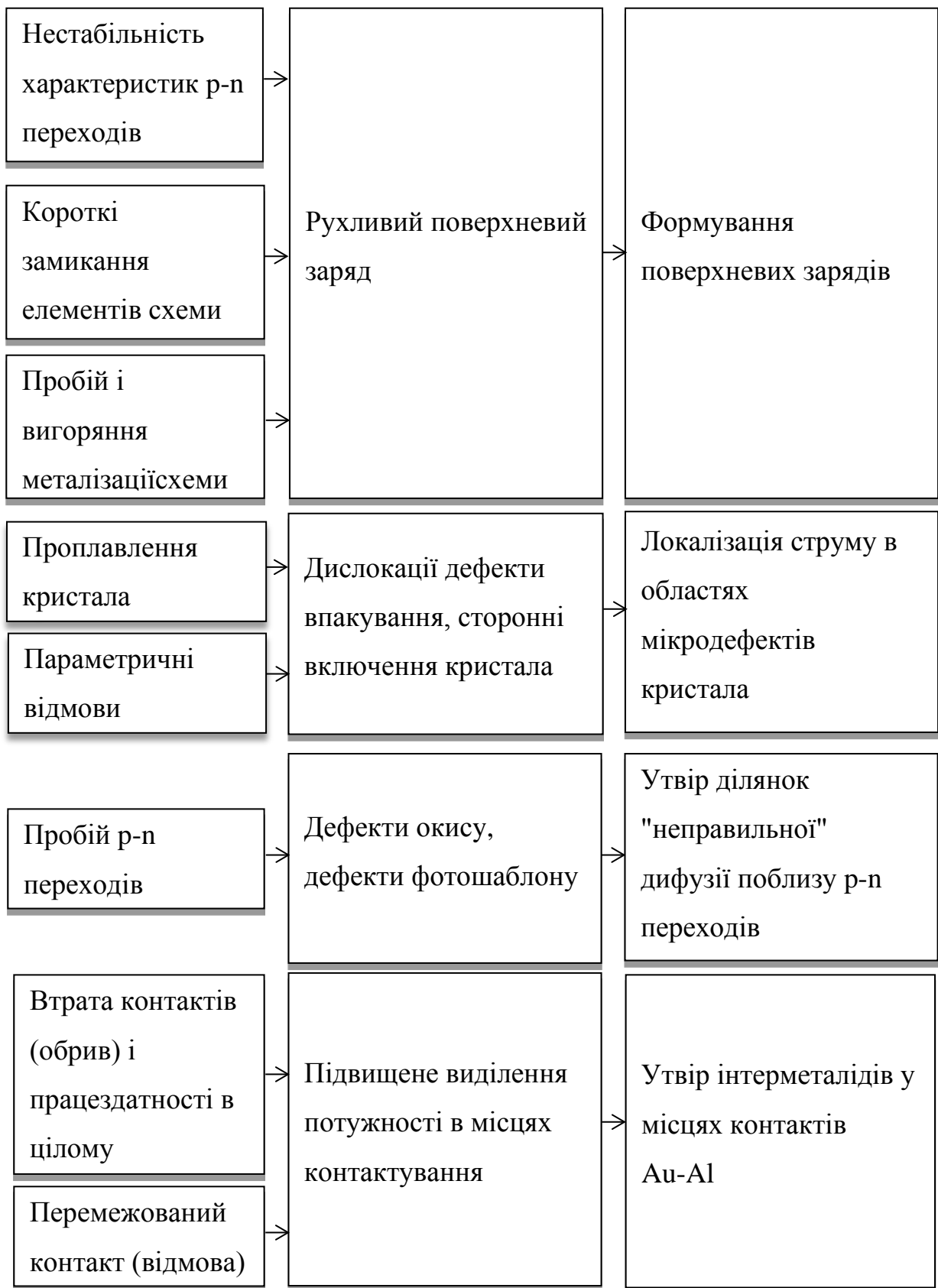
Рис. 2.3. Процеси деградації кремнієвих інтегральних мікросхем
