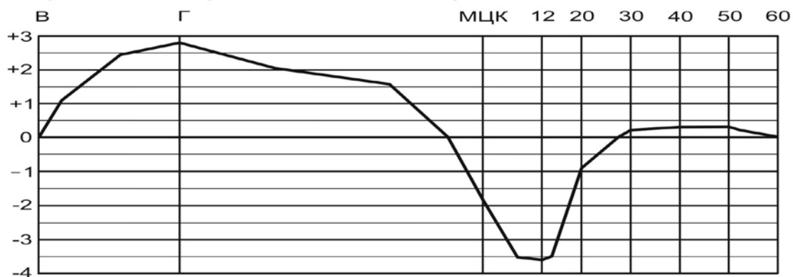
Стрілочний перевід № 7 ст. Дарниця ПШ T=62,9
