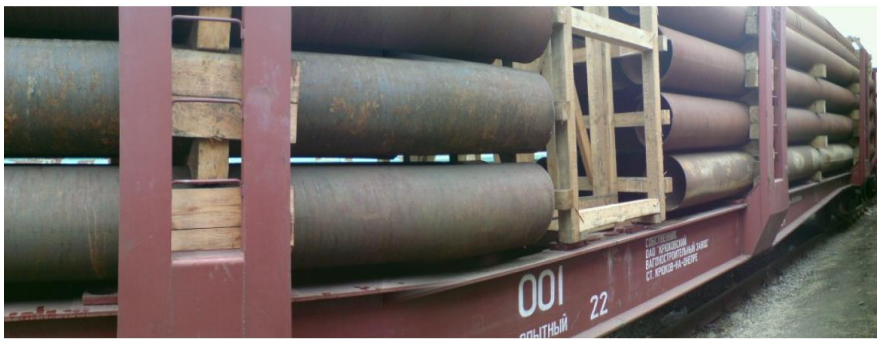
Рисунок 1.2.- Довгобазний вагон-платформа моделі 13-7031 завантажений трубами великого діаметру
