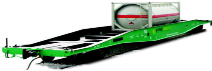
Рисунок 1.8 - Довгобазний вагон-платформа з укороченою хребтовою балкою моделі 13-2118
