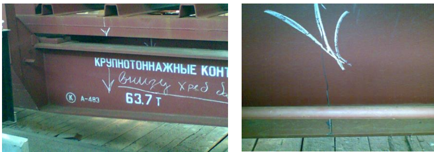
Рисунок 1.11 – Довгобазний вагон-платформа для перевезення контейнерів та довгомірних вантажів. Руйнування бокової балки у перехідному перерізі рами
