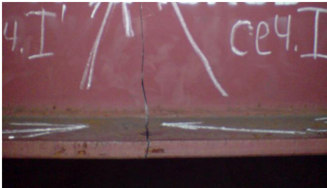
Рисунок 1.11 – Довгобазний вагон-платформа для перевезення контейнерів та довгомірних вантажів. Руйнування бокової балки у перехідному перерізі рами
