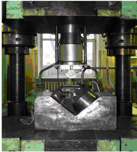
Рисунок 2.22 – Стендове обладнання для випробувань фрикційних клинів на руйнуюче навантаження
