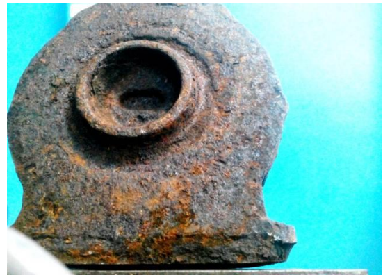
Рисунок 3.7 – Поверхні дотику трибологічної пари «фрикційний клин – фрикційна планка»
