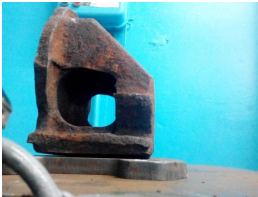
Рисунок 3.7 – Поверхні дотику трибологічної пари «фрикційний клин – фрикційна планка»
