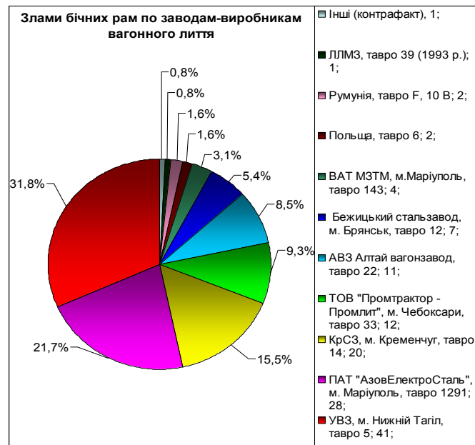
Рисунок 1.3 – Розподіл зламів бічних рам візків вантажних вагонів по заводам-виробникам вагонного лиття за 2006 – 2014 рр.
