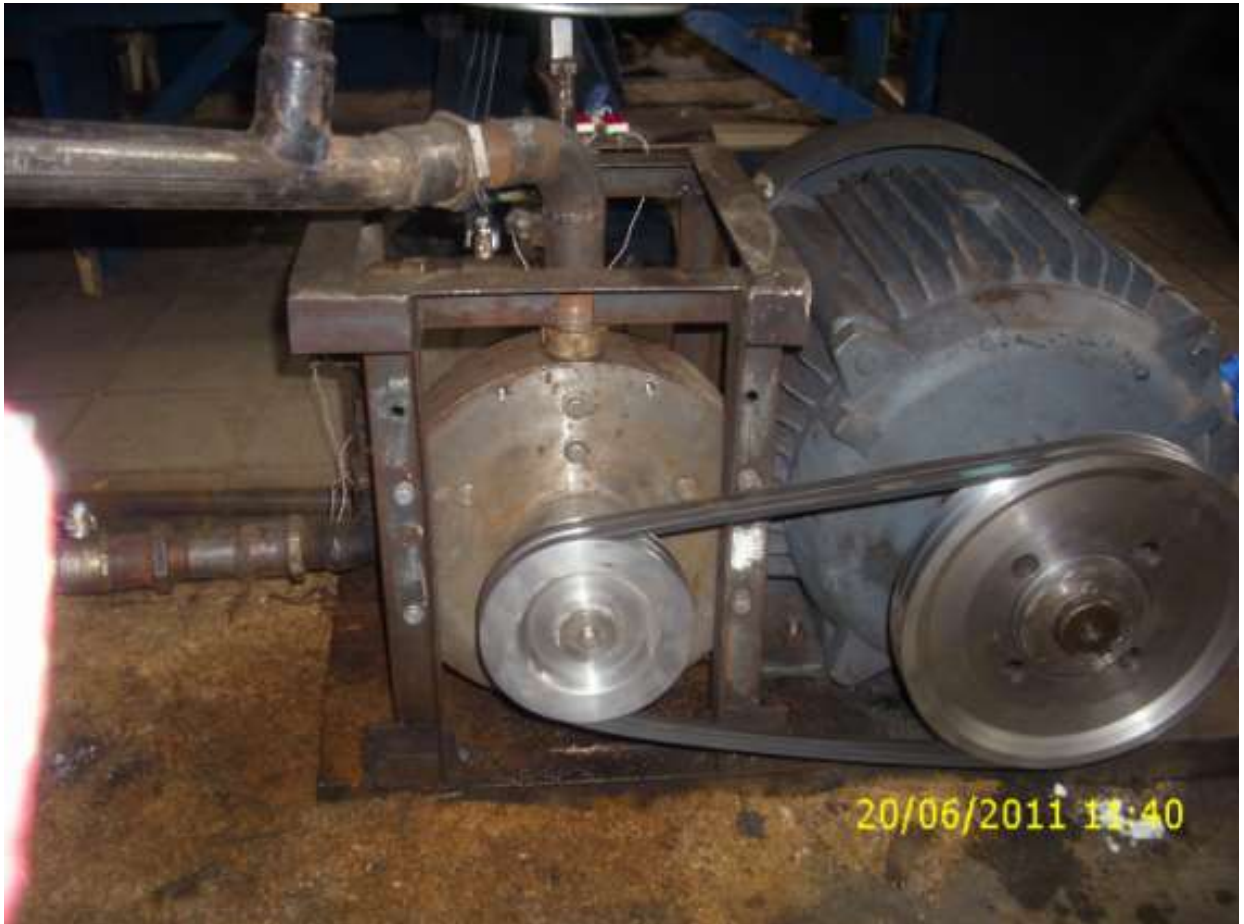
Рисунок Б.4 – Кавітаційний насос-теплогенератор (використовується для прискорення хімічних реакцій)
