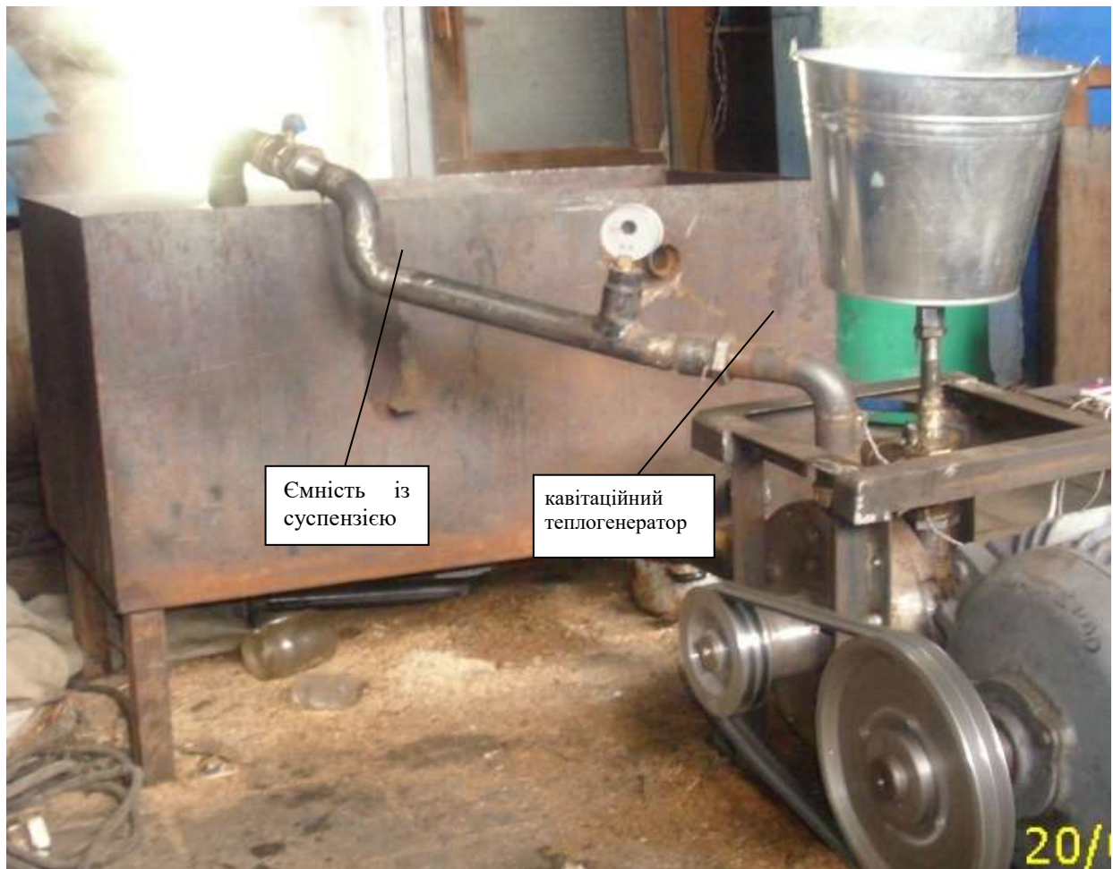
Рисунок Б.6 – Експериментальна установка для очищення стічних вод на базі кавітаційного теплогенератора
