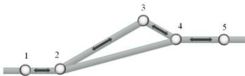
Рисунок 3.4 – Схема фрагмента міжрегіонального рівня виробничої системи з обраними ділянками просування вантажних транзитних потоків
