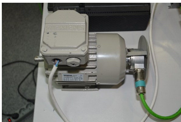
Рисунок 4.13 – Електродвигун 1LE15010CB321AA4-Z з енкодером 1XP8012-10/1024
