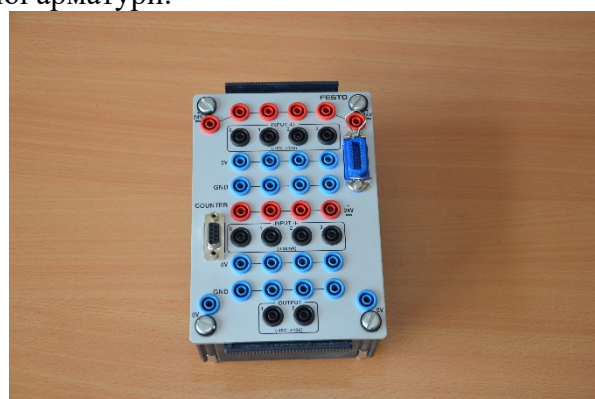
Рисунок 4.4 – Блок входів аналоговий Anschlussinheit-AF TN162247 Serie M8
