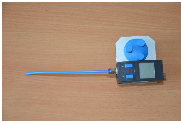
Рисунок 4.7 – Датчик витрат повітря SFAB-1000U-M12
