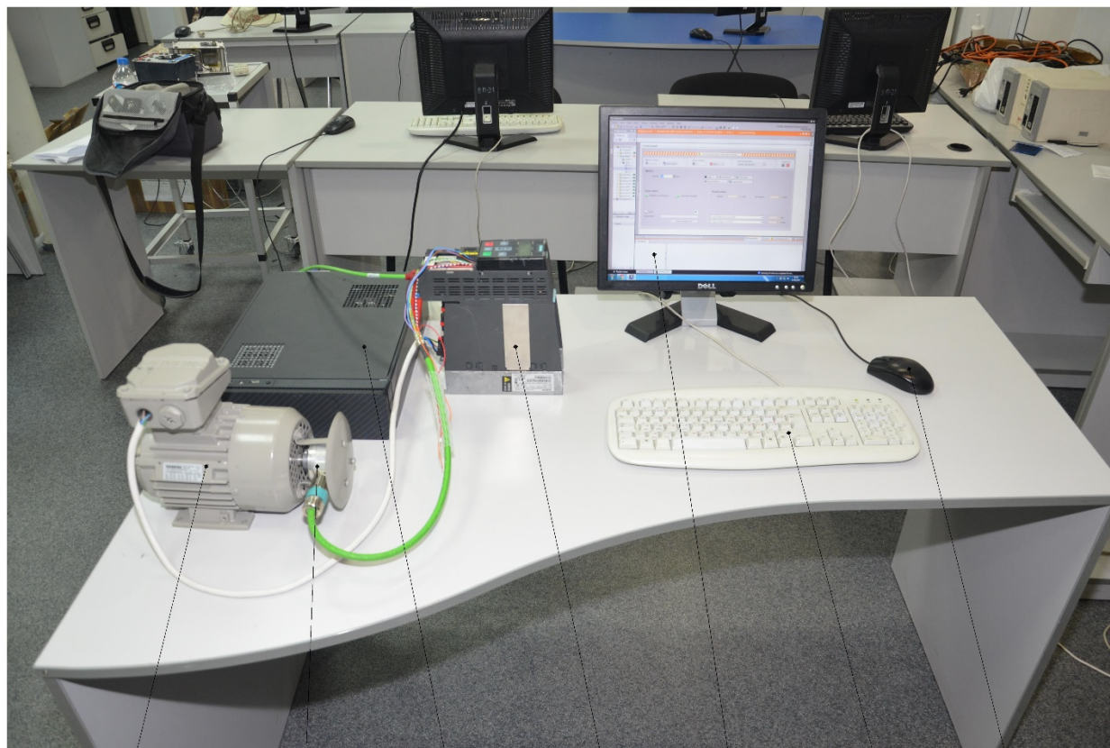
Рисунок 4.12 – Загальний вигляд органів установки для керування обертами шнеку: 1 – електродвигун; 2 – енкодер; 3 – системний блок комп'ютера; 4 – частотний перетворювач; 5 – монітор; 6 – клавіатура; 7 – мишка
