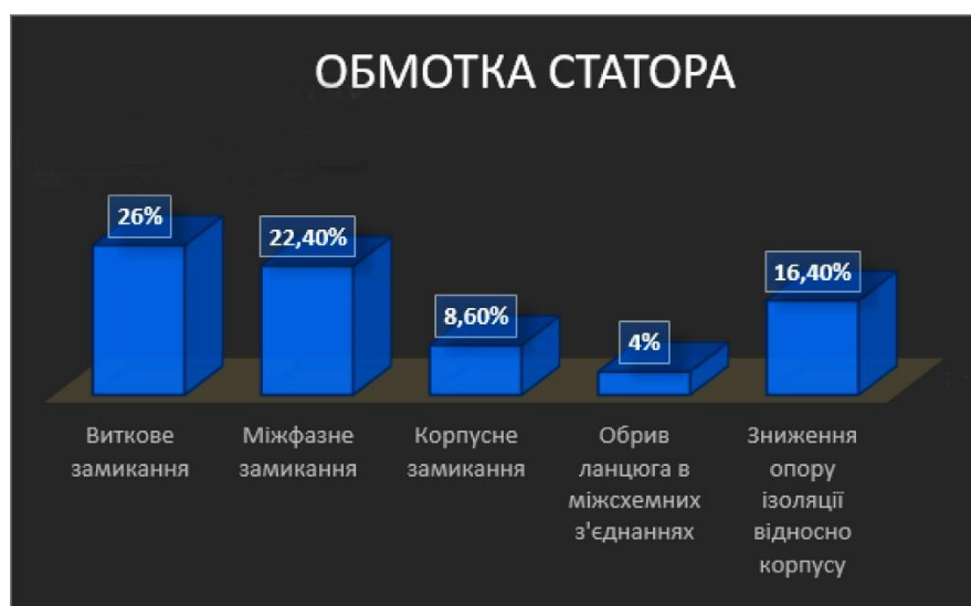
Рис. 1. Причини пошкоджень обмотки статора АД
