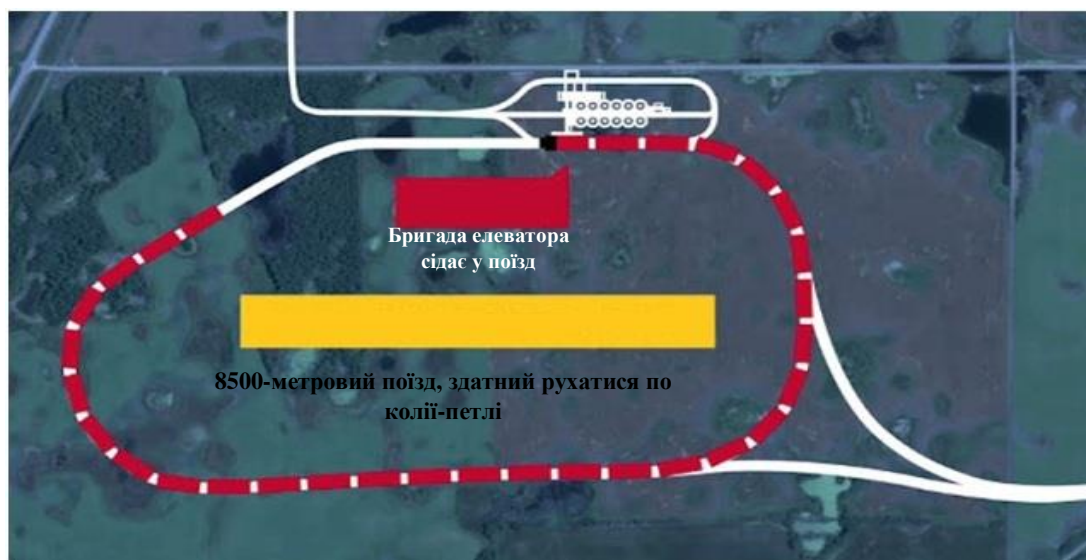
Рис. 3. Схематичне зображення спеціальних колій-петель – a loop-track/power-on setup
