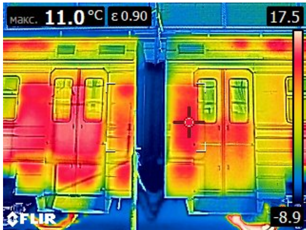
Рис. 1 Термограма дверей електропоїзда
