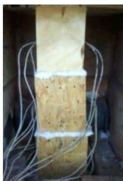
Рис. 1. Фото та схема розташування термопар для зняття температурних показників в шарах фрагментів дерев'яних колон
