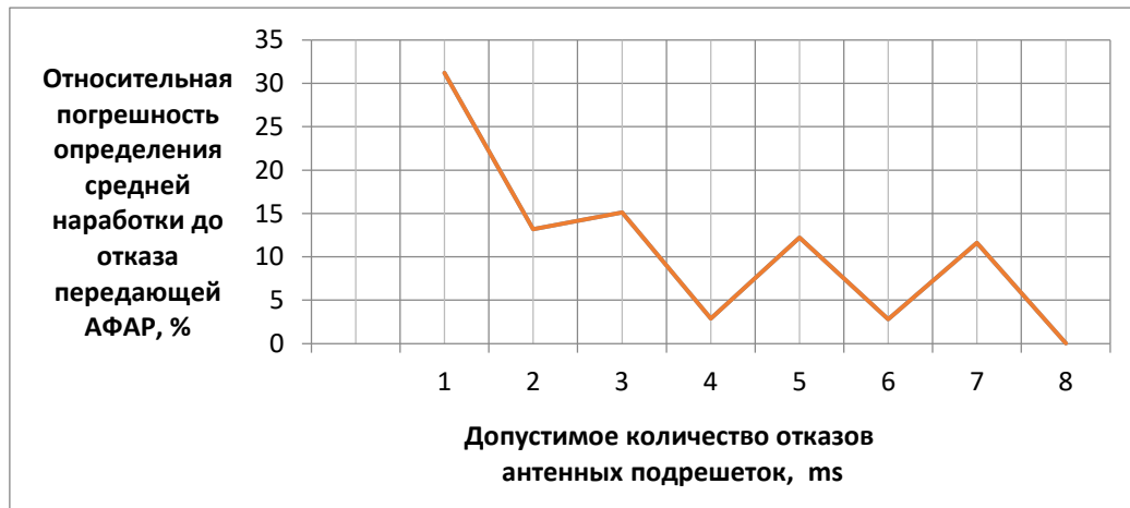
Рис. 3. График зависимости относительной погрешности определения средней наработки до отказа передающей АФАР от допустимого количества отказов антенных подрешеток
