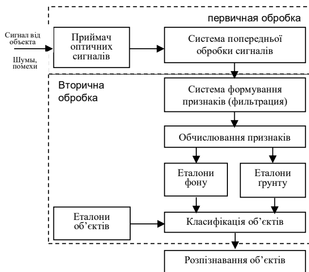
Рисунок 1 – Структурна схема оптико-електронного тракту
