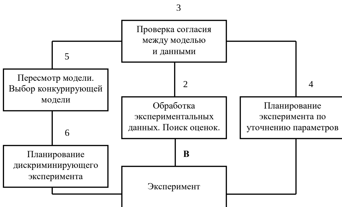
Рисунок 2 – Последовательный процесс поиска математической модели
