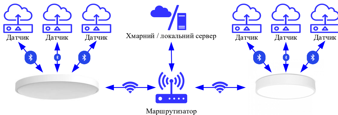
Рисунок 1 – Топологія зв'язку Bluetooth та Wi-Fi пристроїв у системі розумного дому
