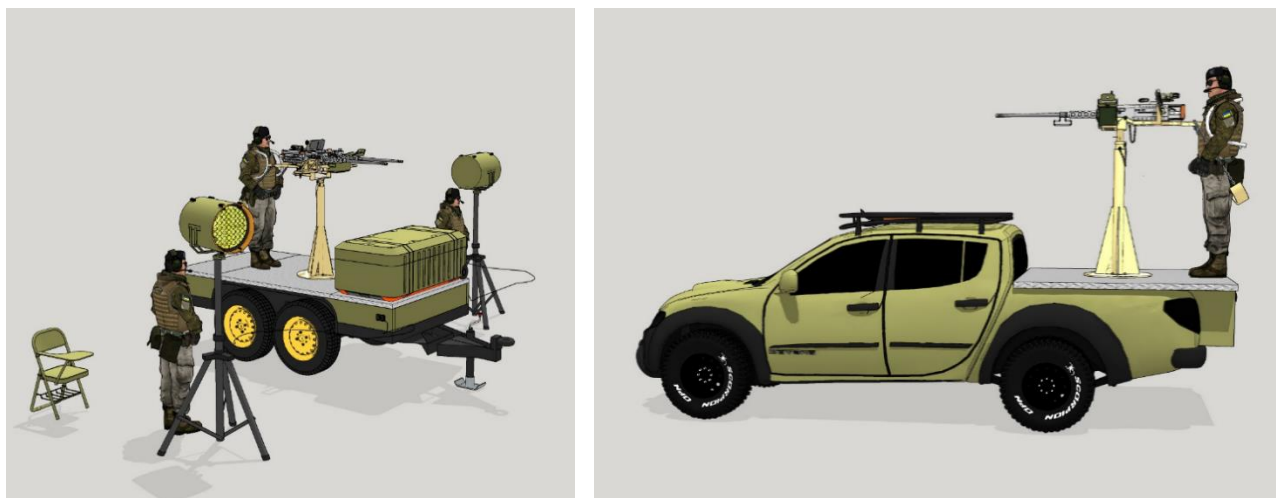
Рисунок 1 – Високомобільна платформа-причеп та платформа, яка встановлена на пікапі відповідно
