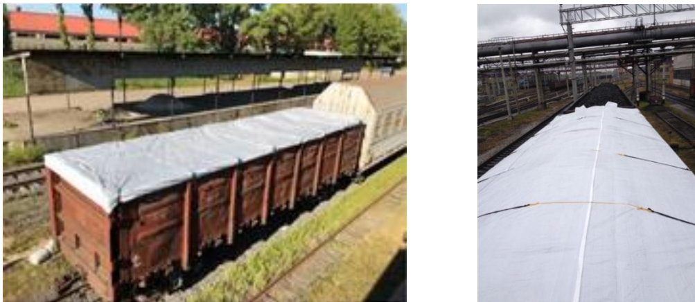
Рисунок 2 – Вагонне укриття двошарове (зовнішній шар - поліпропілен, внутрішній - поліетилен).
