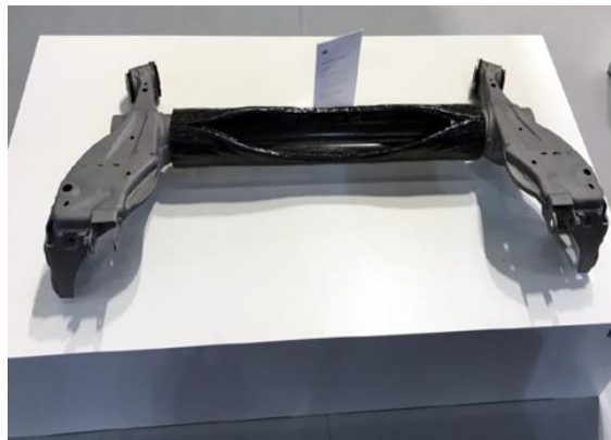
Рисунок 1 – Посилення несучої металеві конструкції композитними елементами
