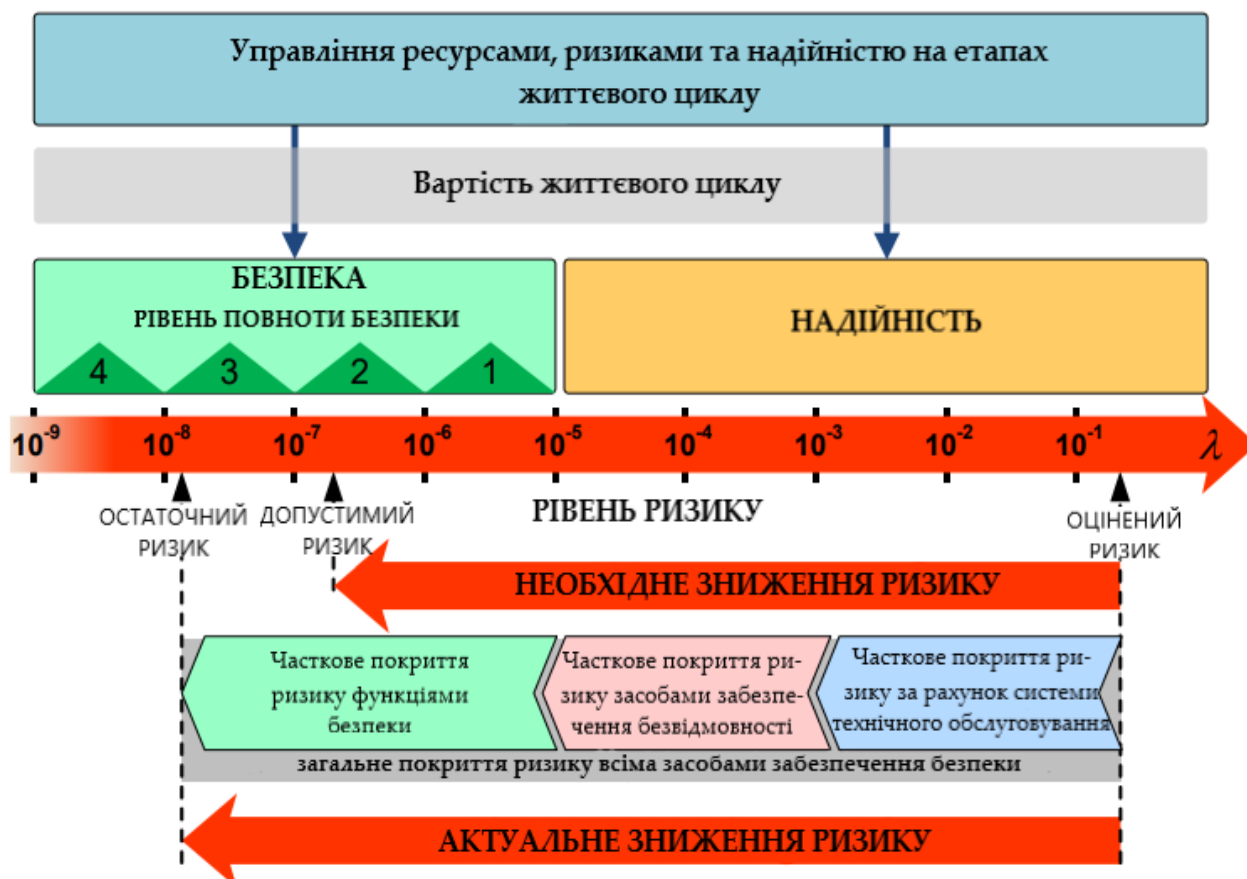
Рисунок 2.1 – Основні компоненти комплексного управління надійністю, безпекою, ризиками та ресурсами на залізничному транспорті
