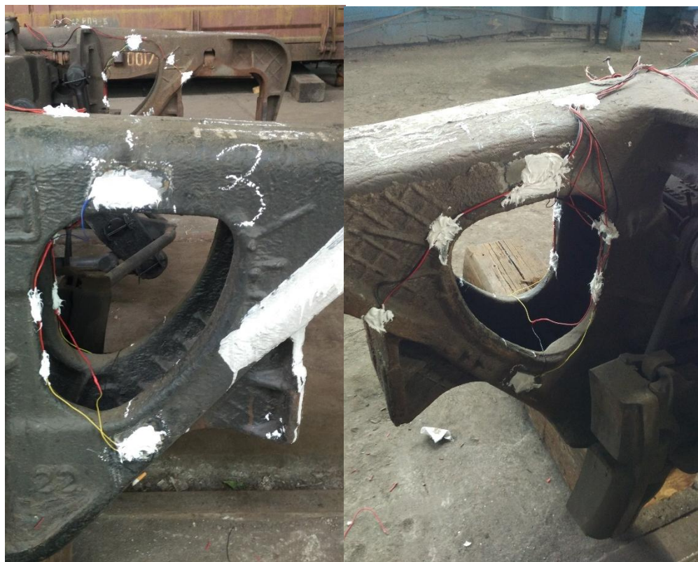
Рисунок 3.21 – Канал 3 на правій боковій рамі візка вагона № 90687609
