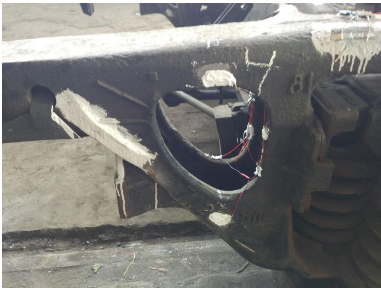
Рисунок 3.22 – Канал 4 на лівій боковій рамі візка вагона № 90687609
