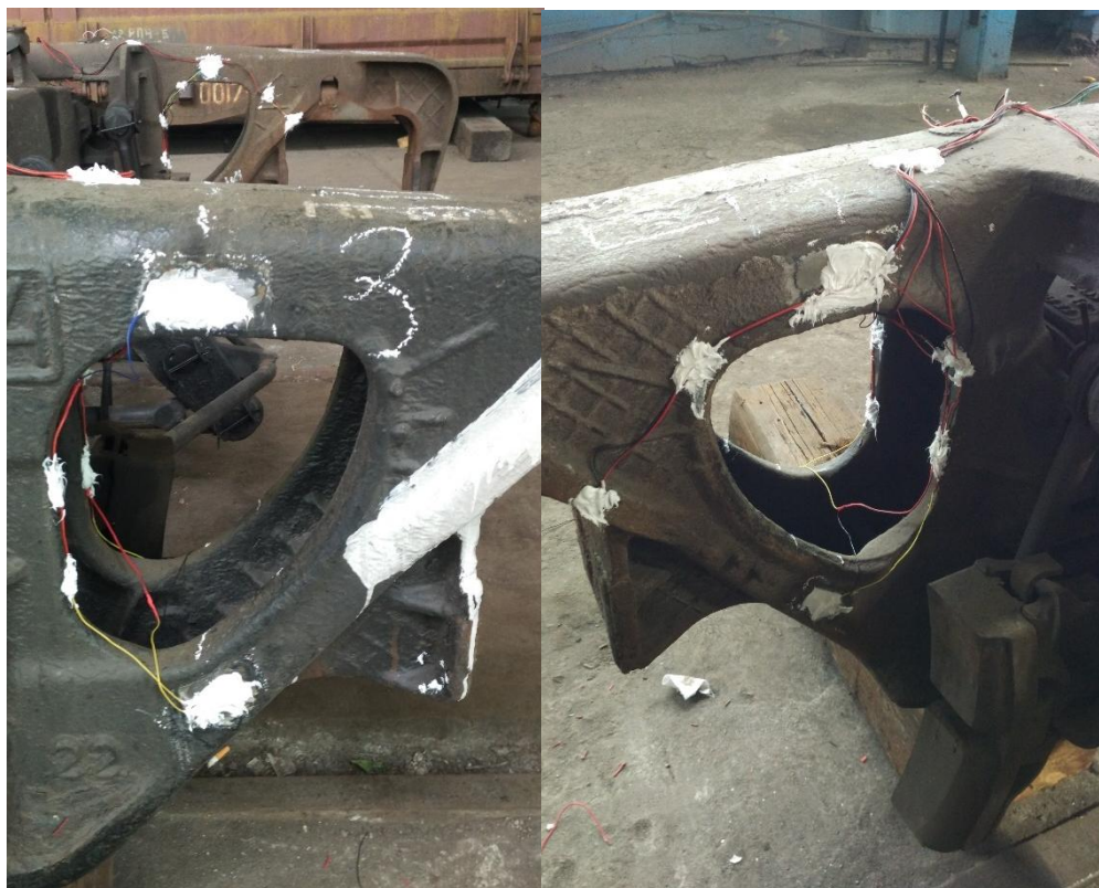
Рисунок 3.14 – Приклад встановлених засобів вимірювальної техніки на боковій рамі
