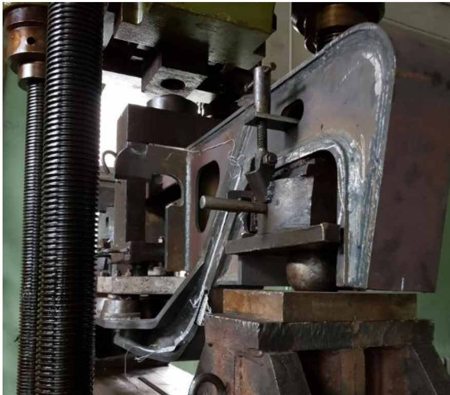
Рисунок 1.26 – Перспективна зварна конструкція бічної рами візка
