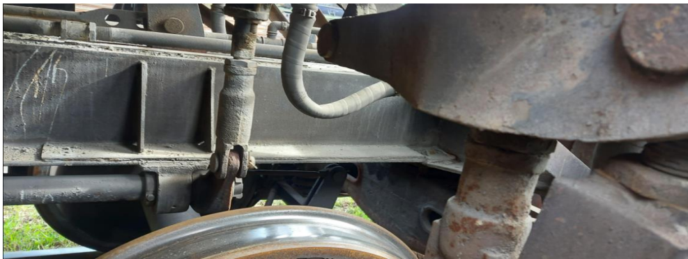
Рисунок 4.33 – Приклад вагона з ребрами жорсткості на хребтовій балці
