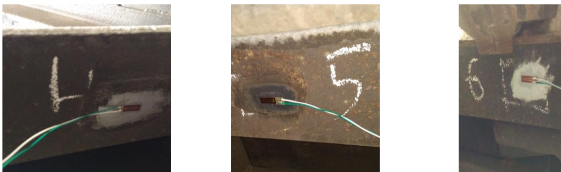
Рисунок 3.5 – Тензодатчики 4, 5, 6 на хребтовій балці хопер-дозатора
