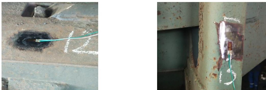
Рисунок 3.10 – Тензодатчики 12, 13 на лобовому брусі та на стойці торцевої стіни думпкара
