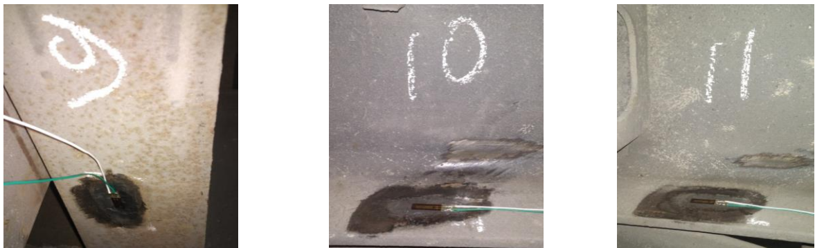
Рисунок 3.9 – Тензодатчики 9, 10, 11 на проміжній та хребтовій балці думпкара
