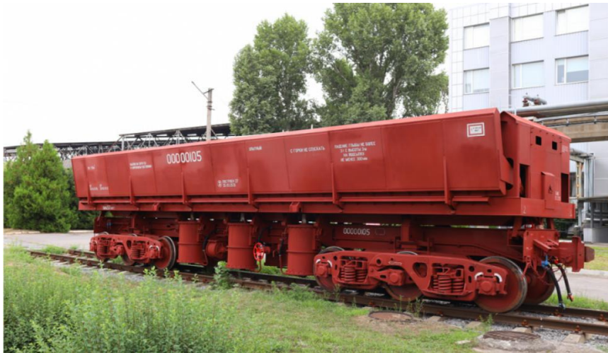
Рисунок 1.1 – Загальний вид вагона-самоскида (думпкара) моделі 33-7141
