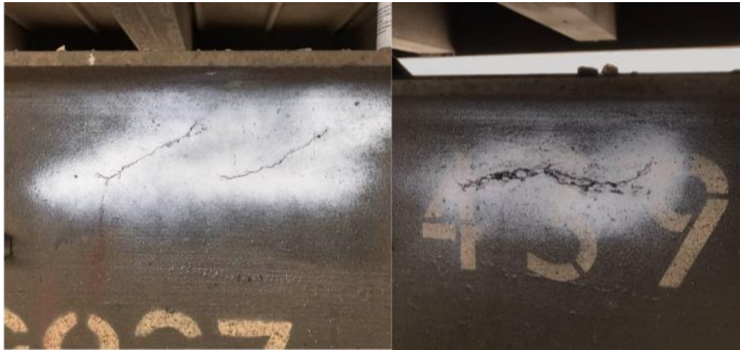
Рисунок 4.29 – Однотипні тріщини на хребтовій балці нижньої рами думпкара
