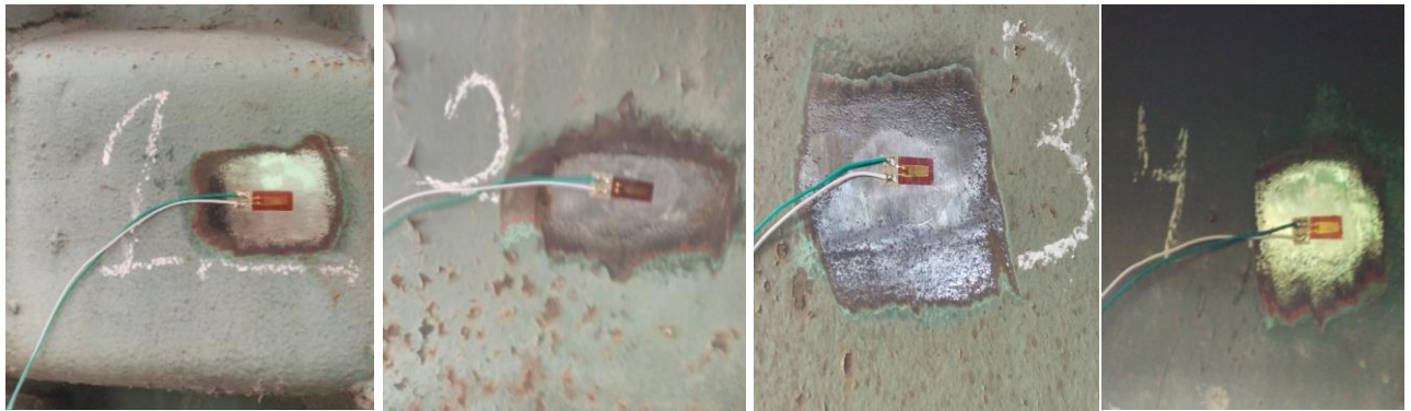
Рисунок 3.7 – Тензодатчики 1, 2, 3, 4 на кузові думпкара
