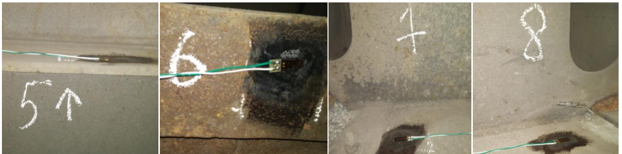
Рисунок 3.8 – Тензодатчики 5, 6 на хребтовій балці та 7, 8 на шворневій балці думпкара
