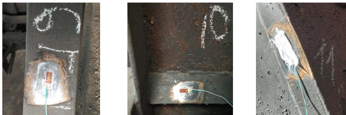
Рисунок 3.6 – Тензодатчики 9, 10, 11 на кузові хопер-дозатора
