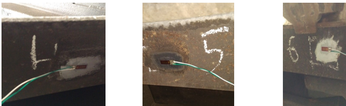
Рисунок 3.5 – Тензодатчики 4, 5, 6 на хребтовій балці хопер-дозатора
