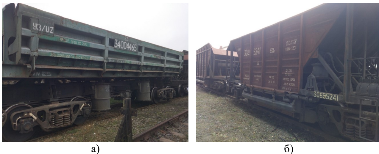
Рисунок 3.1 – Вагони: а) думпкар б) хопер-дозатор
