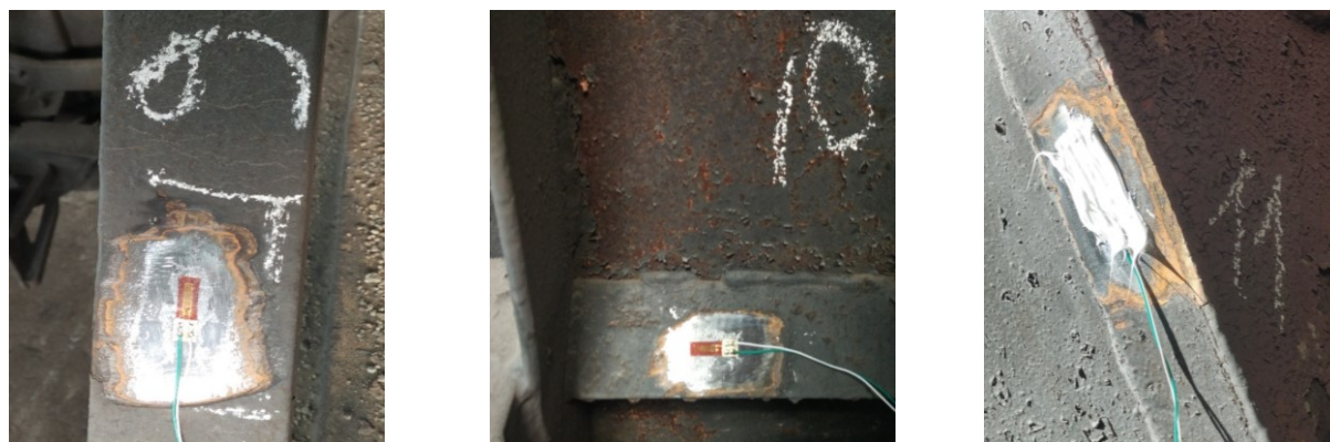
Рисунок 3.6 – Тензодатчики 9, 10, 11 на кузові хопер-дозатора
