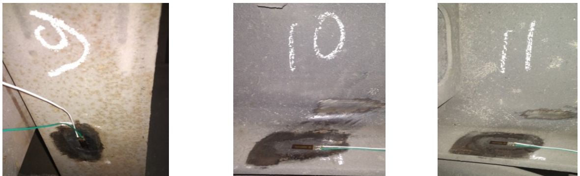
Рисунок 3.9 – Тензодатчики 9, 10, 11 на проміжній та хребтовій балці думпкара
