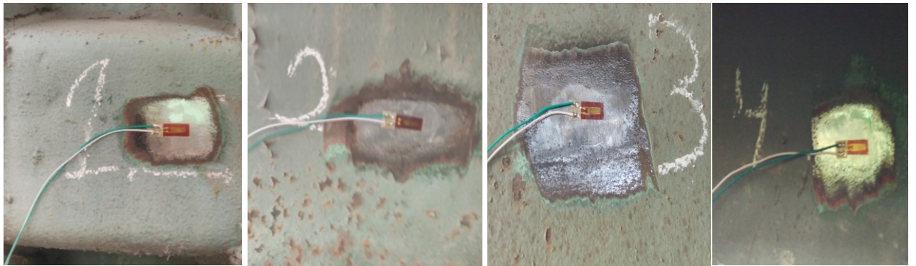
Рисунок 3.7 – Тензодатчики 1, 2, 3, 4 на кузові думпкара
