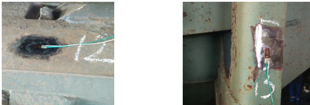
Рисунок 3.10 – Тензодатчики 12, 13 на лобовому брусі та на стойці торцевої стіни думпкара
