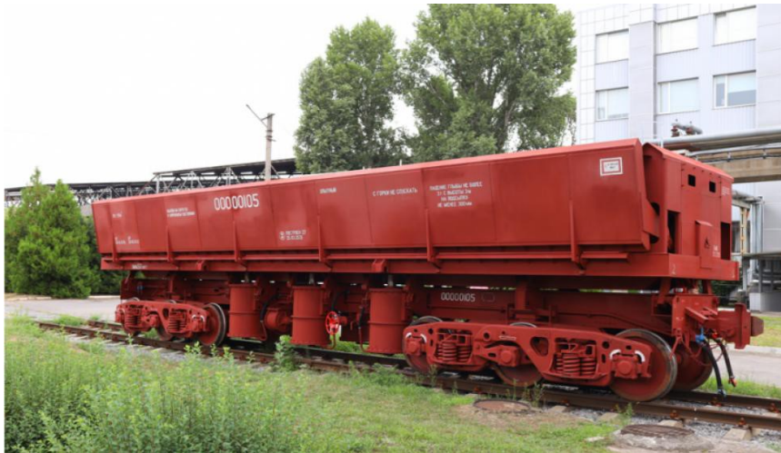
Рисунок 1.1 – Загальний вид вагона-самоскида (думпкара) моделі 33-7141
