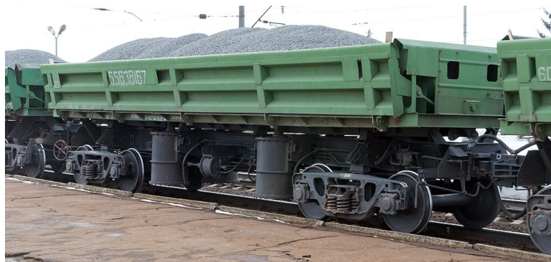
Рисунок 4.1 – Думпкар (вагон-самоскид) моделі 31-638
