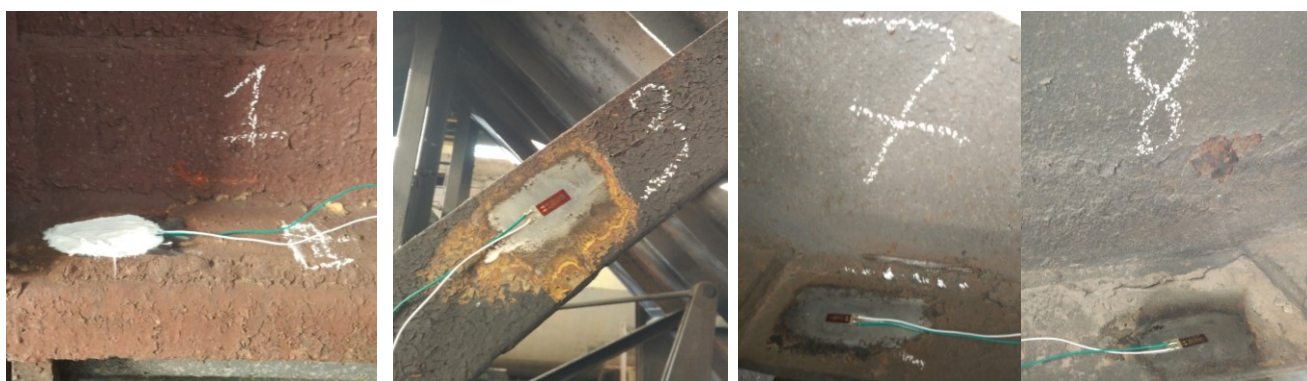
Рисунок 3.4 – Тензодатчики 1, 3 на кузові та 7, 8 на шворневій балці хопер-дозатора
