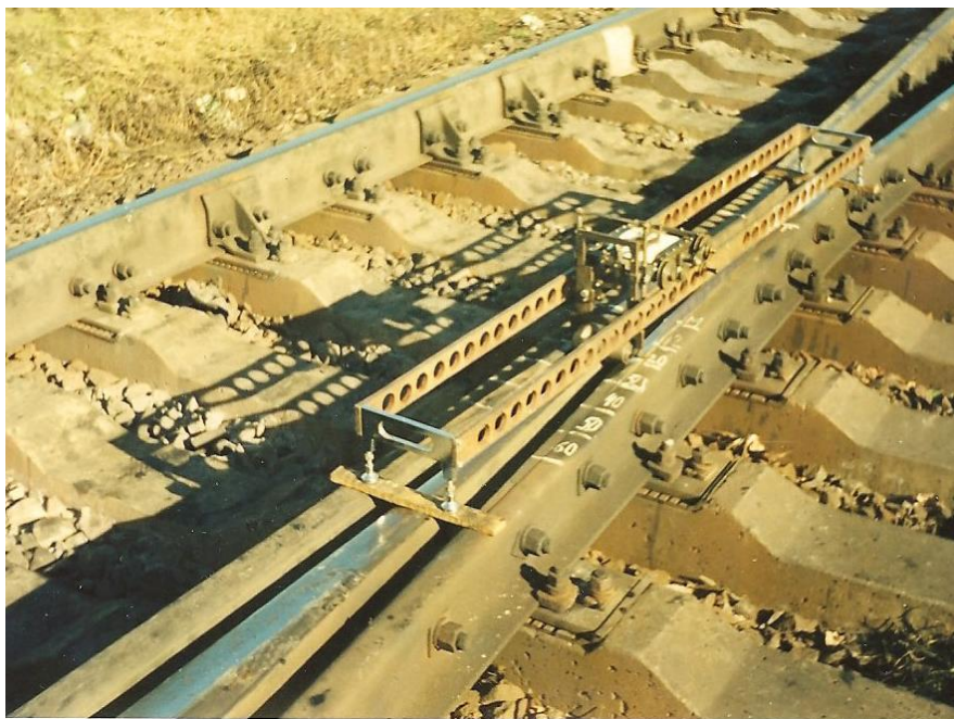
Рис. 2.12 Загальний вигляд траєкторіографа конструкції ЛШЗТу для вимірювання вертикальних нерівностей на хрестовинах
