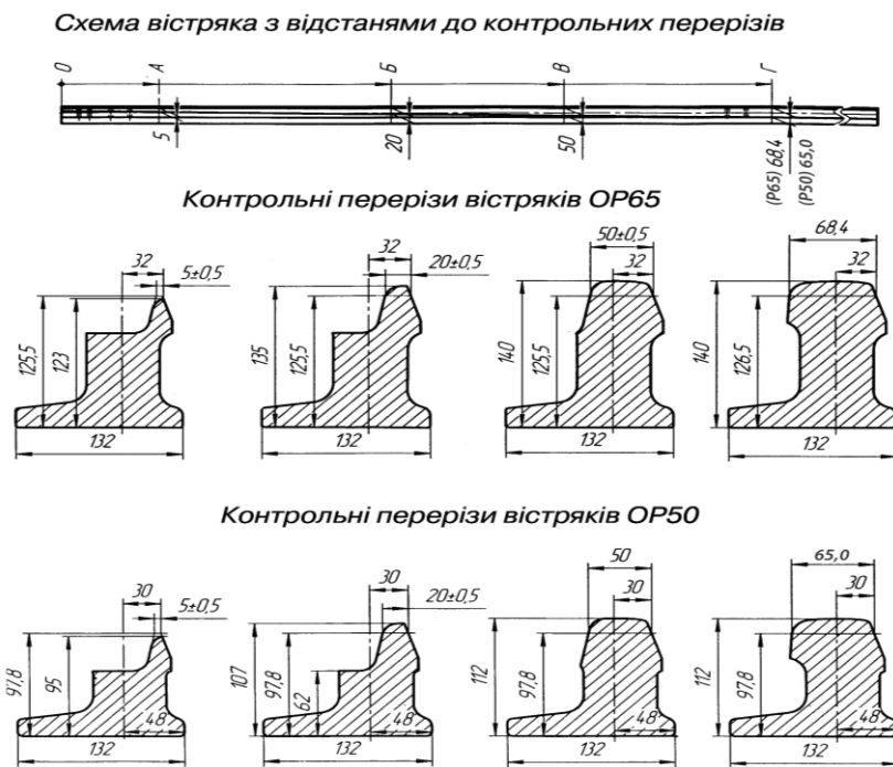
Рис. 3.13 Поздовжні та поперечні профілі вістряків OP65 та OP50
