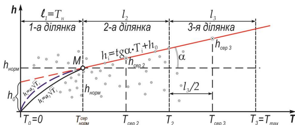
Рис. 5 Схема для визначення рівняння прямої ділянки кривої зносу h = \text{tg} \alpha \cdot T_i + h_0
