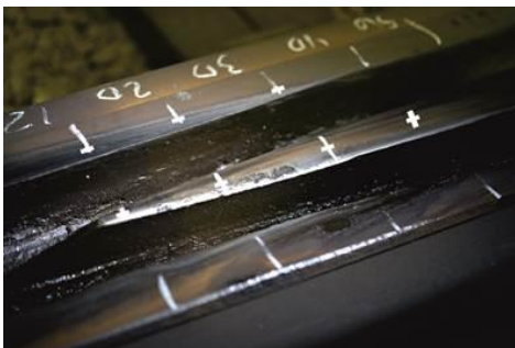
Рис.1 Розмітка перерізів на хрестовинах в коліях метрополітену та схема вимірювань вертикального зносу хрестовин на переводах типів Р50 та Р65 марки 1/9
