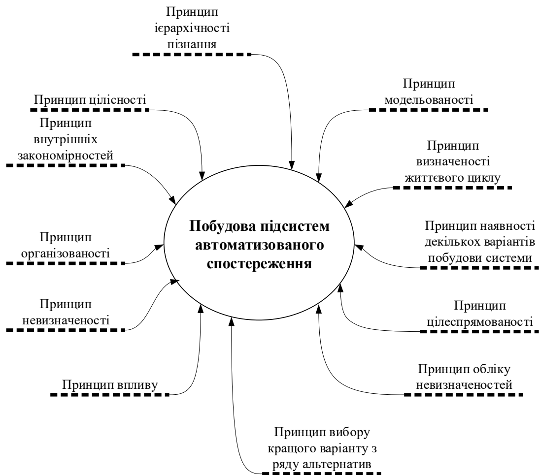
Рис 2.7 – Принципи побудови підсистем автоматизованого спостереження
