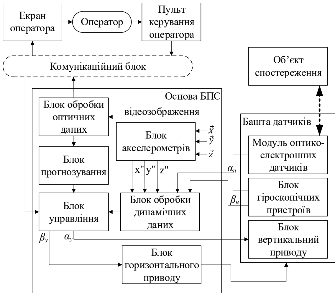
Рис. 4.10 – Функціональна схема впроваджені системи траєкторного стеження
