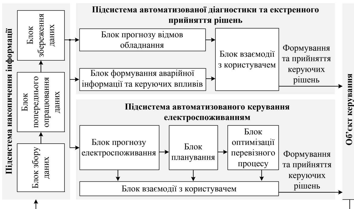
Рис. 1.6. Інтелектуалізована інформаційна система керування електропостачанням залізниці
