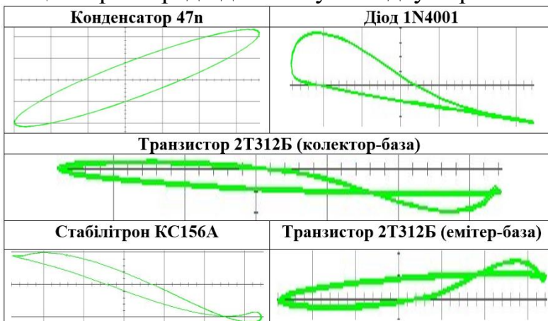
Таблиця 2 Осцилограми радіодеталей у випадку справності
