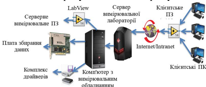
Рисунок 2 – Комп'ютеризована система діагностування радіоелектронних систем до якого під'єднаний комп'ютер з вимірювальним обладнанням.
