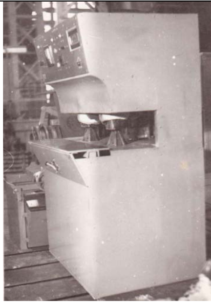
Рис. И.5 Двохпозиційна тороїдальна індукційна установка для нагріву підшипників і напівмуфт (1971 р.)
