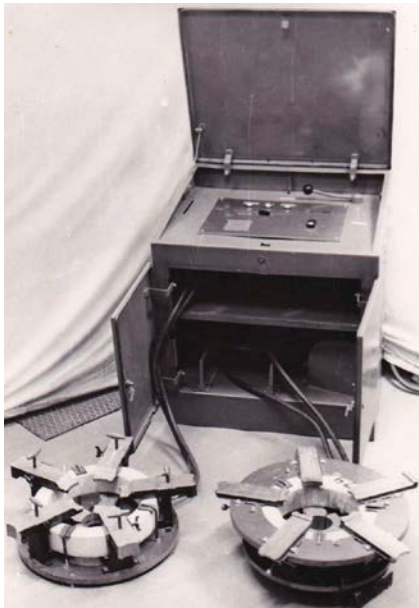
Рис. И.11 Индукционная установка для разборки деталей осевого редуктора тепловозов типа ТУ (1972 г.)
