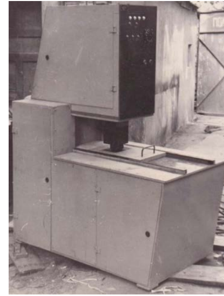
Рис. И.4 Індукційна установка для нагріву деталей механізмів суден типу «Казбек» (1968 р.)
