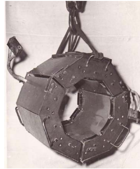
Рис. И.22 Індукційно–нагрівальний пристрій для знімання фланців гребного валу СРТМ (1974 р.)
