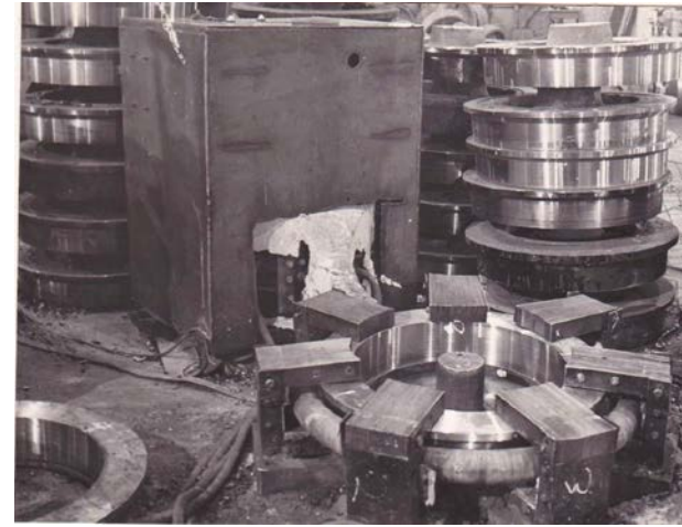
Рис. И.8 Індукційна установка для швидкісного нагріву бандажів коліс тепловозів типу ТУ (1972 р.)
