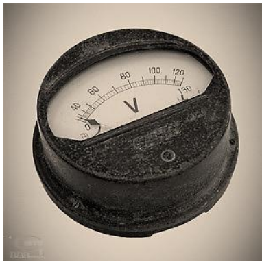
Рисунок Г.1 – Вольтметр змінного струму електромагнітної системи. Межа вимірювання 130 В. Виробник – Ленінградський завод «Електроприлад»
