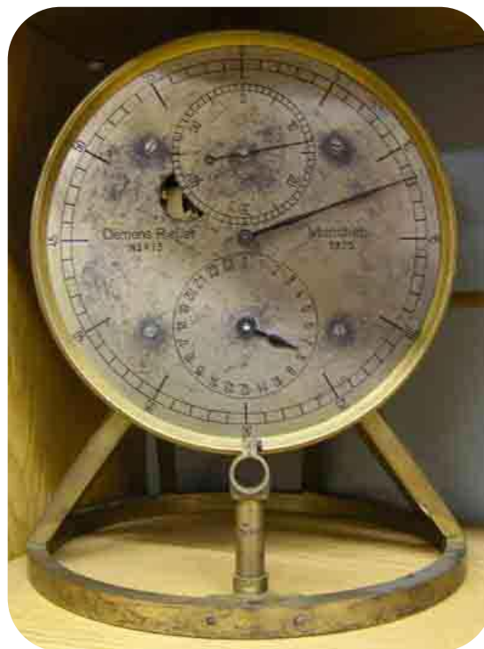
Рисунок В.3 – Маятниковий годинник Рифлера з точністю ходу 0,01 с/добу, які використовувалися в службі часу і частоти з 1925 по 1941 рік
