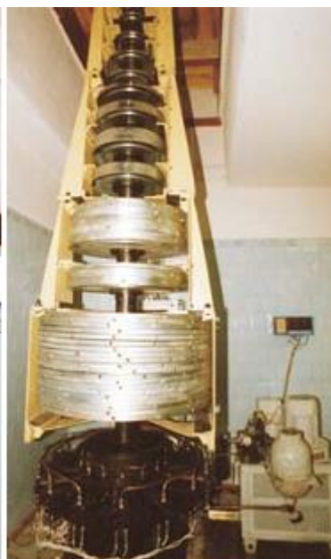
Рисунок 3.4 – Державний первинний еталон одиниць твердості за шкалами Брінелля та Віккерса (ДЕТУ 02-03-99)
