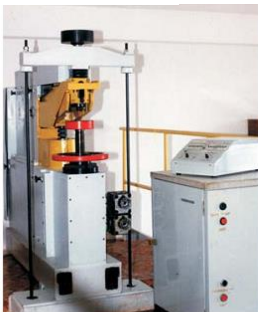
Рисунок 3.4 – Державний первинний еталон одиниць твердості за шкалами Брінелля та Віккерса (ДЕТУ 02-03-99)
