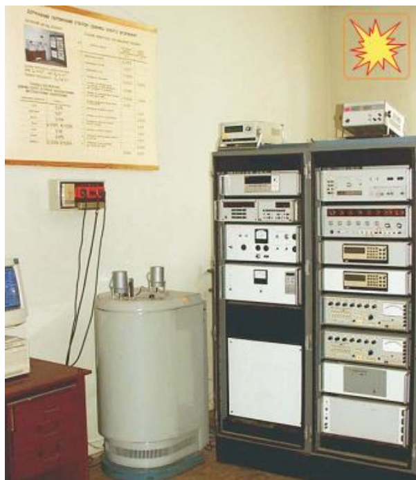
Рисунок 3.6 – Державний первинний еталон одиниці енергії згоряння (ДЕТУ 06-04-97)
