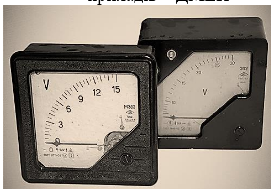
Рисунок Г.4 – Зліва – вольтметр постійного струму магнітоелектричної системи типу М362. Рік випуску – 1959. Праворуч – вольтметр змінного струму електромагнітної системи типу ЕП2. Рік випуску – 1956.
