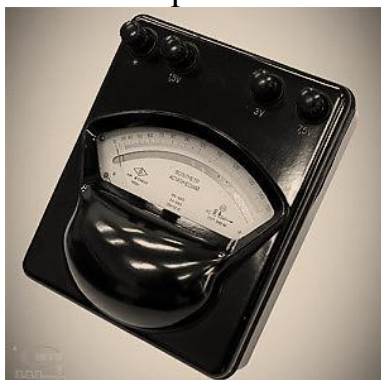
Рисунок Г.7 – Вольтметр астатичний лабораторний АВН. При класі точності 0,5 забезпечує вимірювання змінної напруги в діапазонах 1,5; 3; 7,5 В.Рік випуску – 1950
