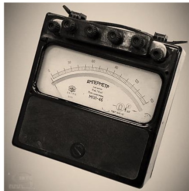
Рисунок Г.2 – Лабораторний амперметр постійного струму магнітоелектричної системи. Виготовлений в 1948 році Державним Московським заводом приладів – ДМЕП
