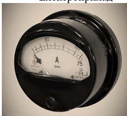
Рисунок Г.3 – Амперметр щитового виконання типу ЕММ. Межа виміру 75 А, клас точності – 2,5, виготовлений в 1949 р. заводом ДМЕП
