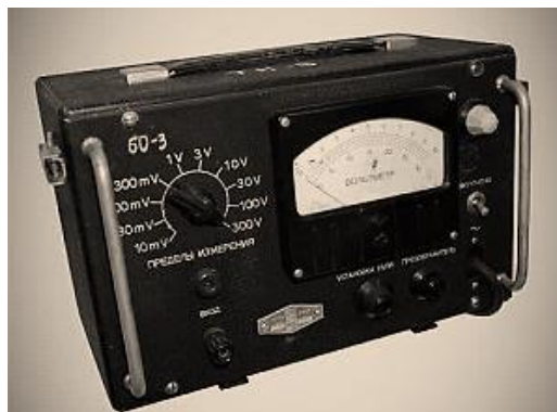
Рисунок Г.8 – Ламповий вольтметр ЛВ-9, призначений для вимірювання напруг з частотою від 30 Гц до 200 кГц. Виготовлений на Талліннському заводі «Пунане РЕТ» в 1954 році
