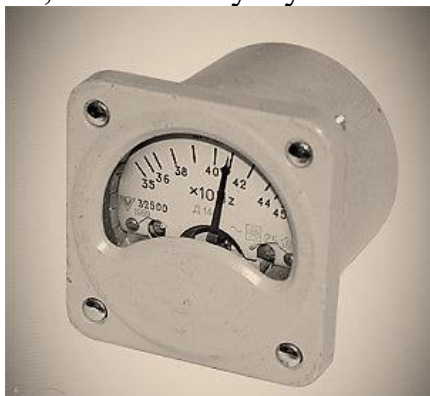
Рисунок Г.9 – Частотомір підвищеної частоти 350-450 Гц типу Д145 – продукція 1965 Ленінградського заводу «Вібратор»
